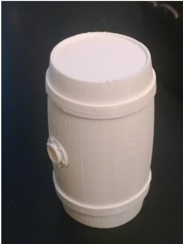
Kuva 25. Kerrosten luoma puu-efekti tynnyrimäisen osan pinnalla
