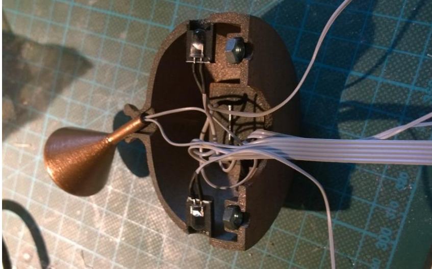
Kuva 29. K1-kysymyslaitteen sisäinen johdotus
