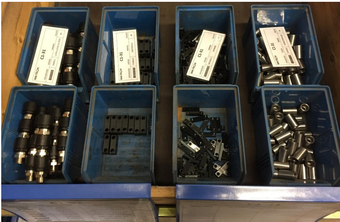
Kuvio 31. Kaksilaatikkojärjestelmä. (MA-Tech Oy 2017.)
