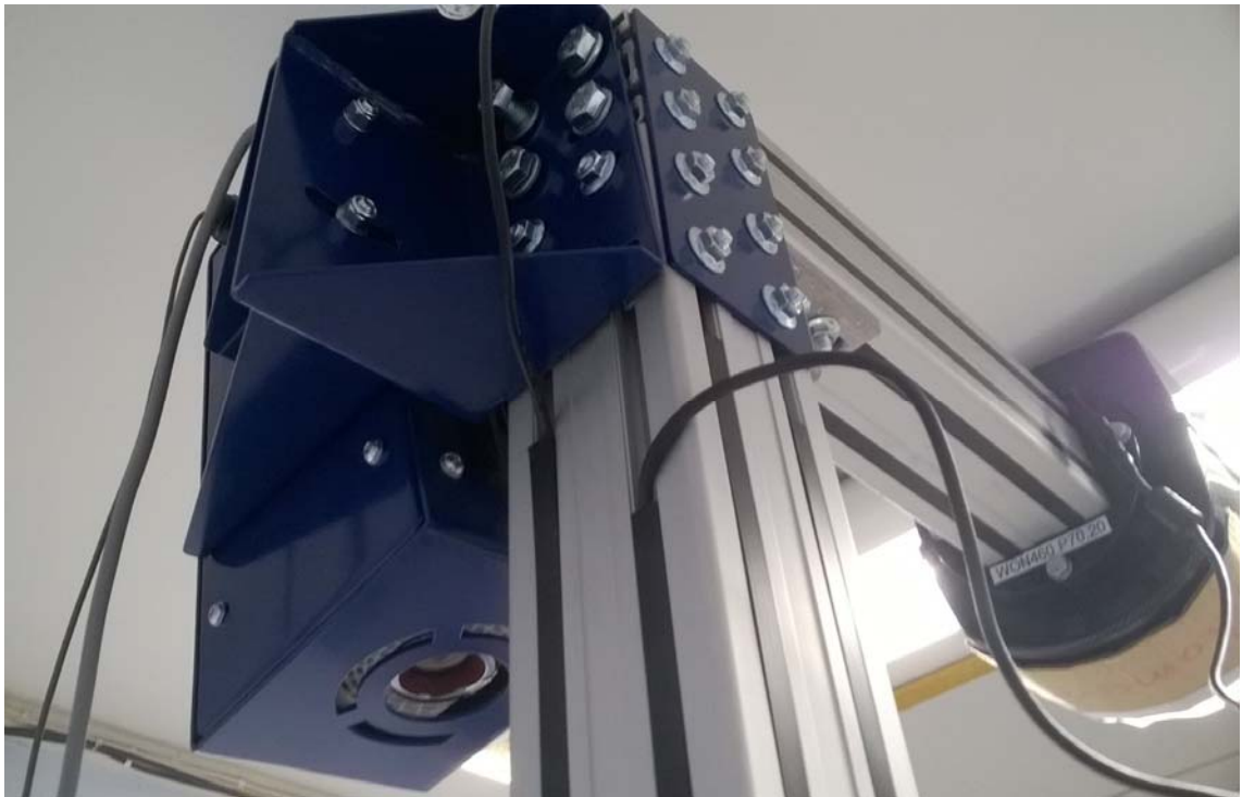
KUVA 9. Kameran ja projektorin kiinnitys
