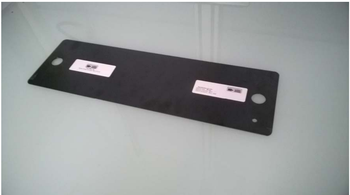
KUVA 15. Metallilevy mittasuhteen kalibroimiseen
