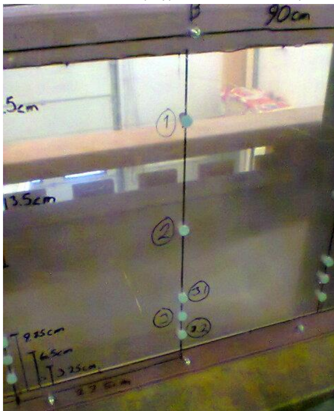
KUVA 3 Mittausmatriisilevyn virtausmittauspisteet esimerkkilinjassa (Meriläinen 2017)
