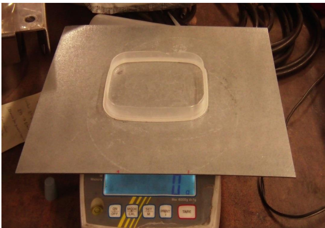
KUVA 9 Näytealusta kehyksineen vaa'alla (Meriläinen 2017)
