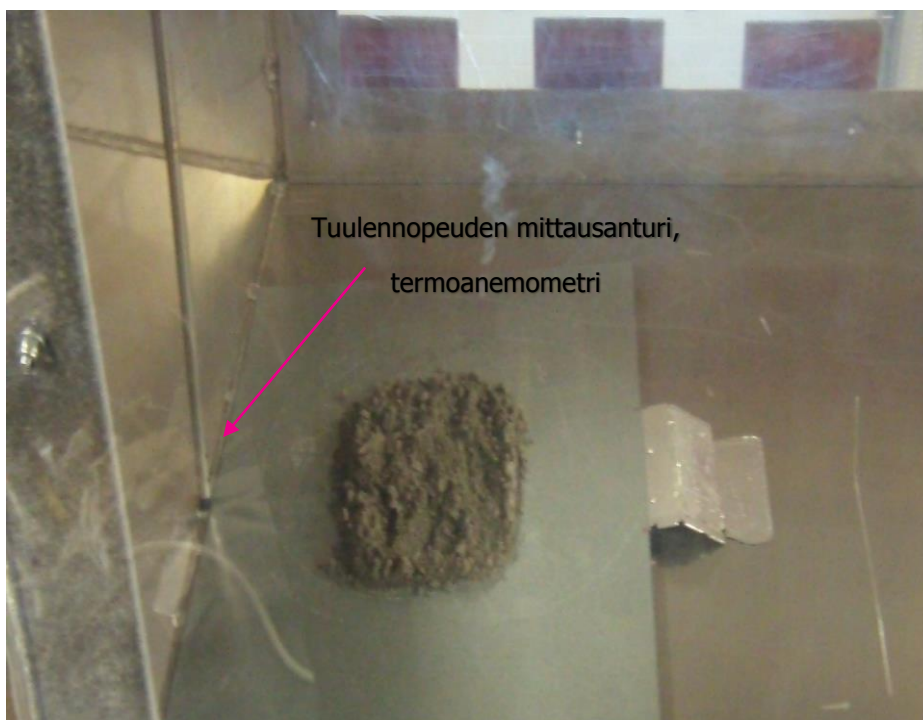
KUVA 10 Tuulennopeuden mittausanturi, termoanemometri, ja näyte asetettuna tuulikammion pohjalle (Meriläinen 2017)
