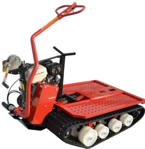
Kuva 2. Puutavaran maastokuljetukseen soveltuva pienmetsäkone. (IronHorse Classic Hunting Edition -rautahepo, [Viitattu 18.3.2017].)
