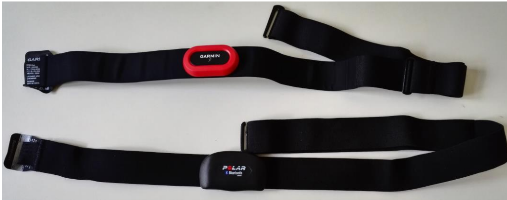
Kuva 3. Tyypillisiä sähköiseen mittaukseen käytettäviä sykevöitä, joissa ulkonäkö on hyvin samanlainen, mutta tekniikka on erilaista.
