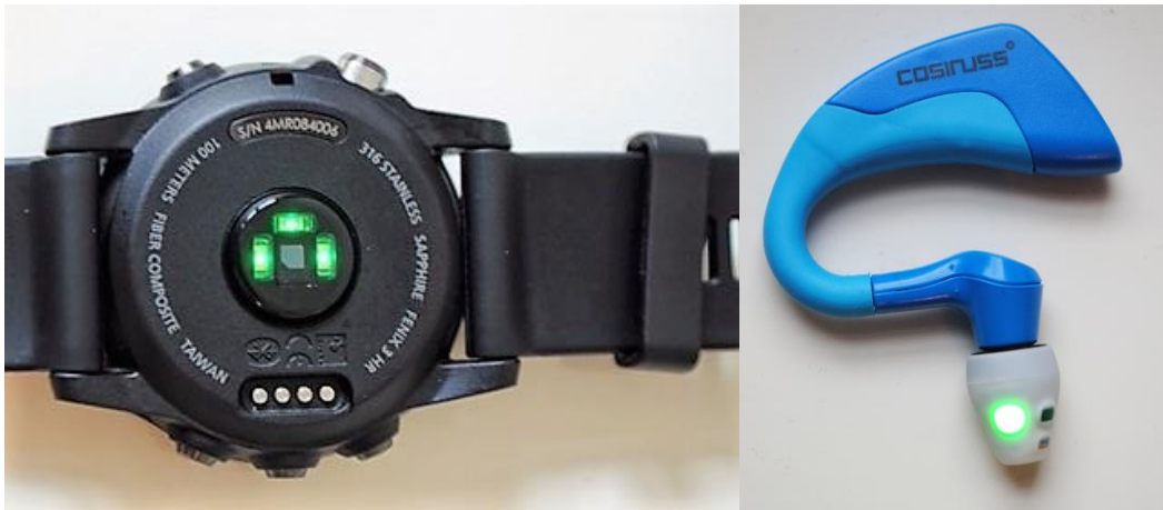
Kuva 6. Hyvä esimerkki optisesta sykemittarista on vasemmalla oleva Garminin Fenix 3 HR multisportkello kolmella vihreällä ledillä. Oikealla Cosinuss One, jossa on vain yksi vihreä led-valo.
