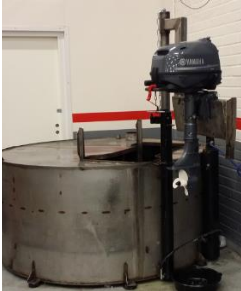
KUVA 16. Nostinlaite perämootorilla kuormitettuna altaan ulkopuolella.
