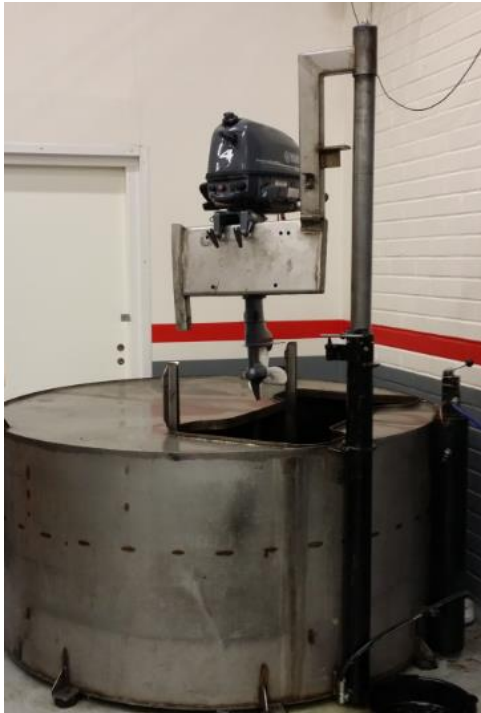
KUVA 17. Nostinlaite perämootorilla kuormitettuna altaan sisäpuolelle käännettynä.
