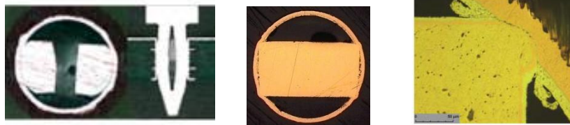
KUVA 2 Vasemmalla neulansilmän muotoinen pinni ja keskellä on kuvattu vinoneliön muotoisen PressFit-pinnin kontaktipinta kupariin piirilevyn reiässä. Oikealla on mikroskooppinen kuva pinnin kontaktista reiässä. (www.JimTrade.com. 2010; www.we-online.com.2010; Wittig, K. 2008.)
