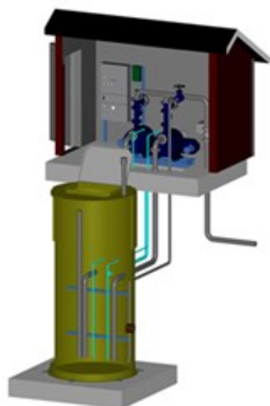
Kuva 14. Itseimevä pumppaamo keskipakopumpuilla (Lining 2017).
