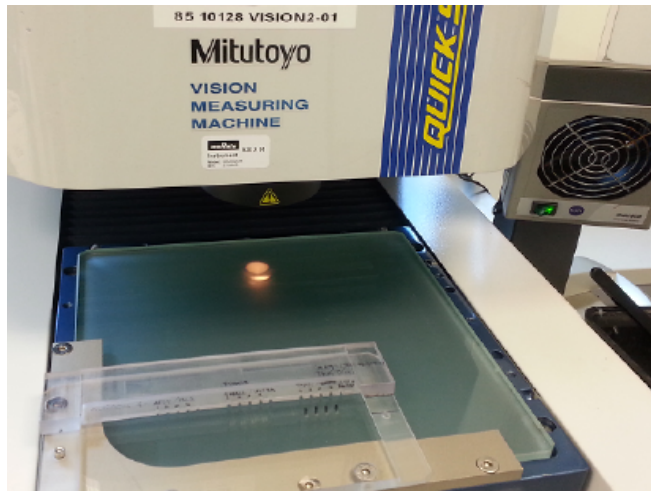
Kuva 17: Vision 2 -mittalaite ja kampa, jolla elementit asetellaan mittausasentoon [22].
