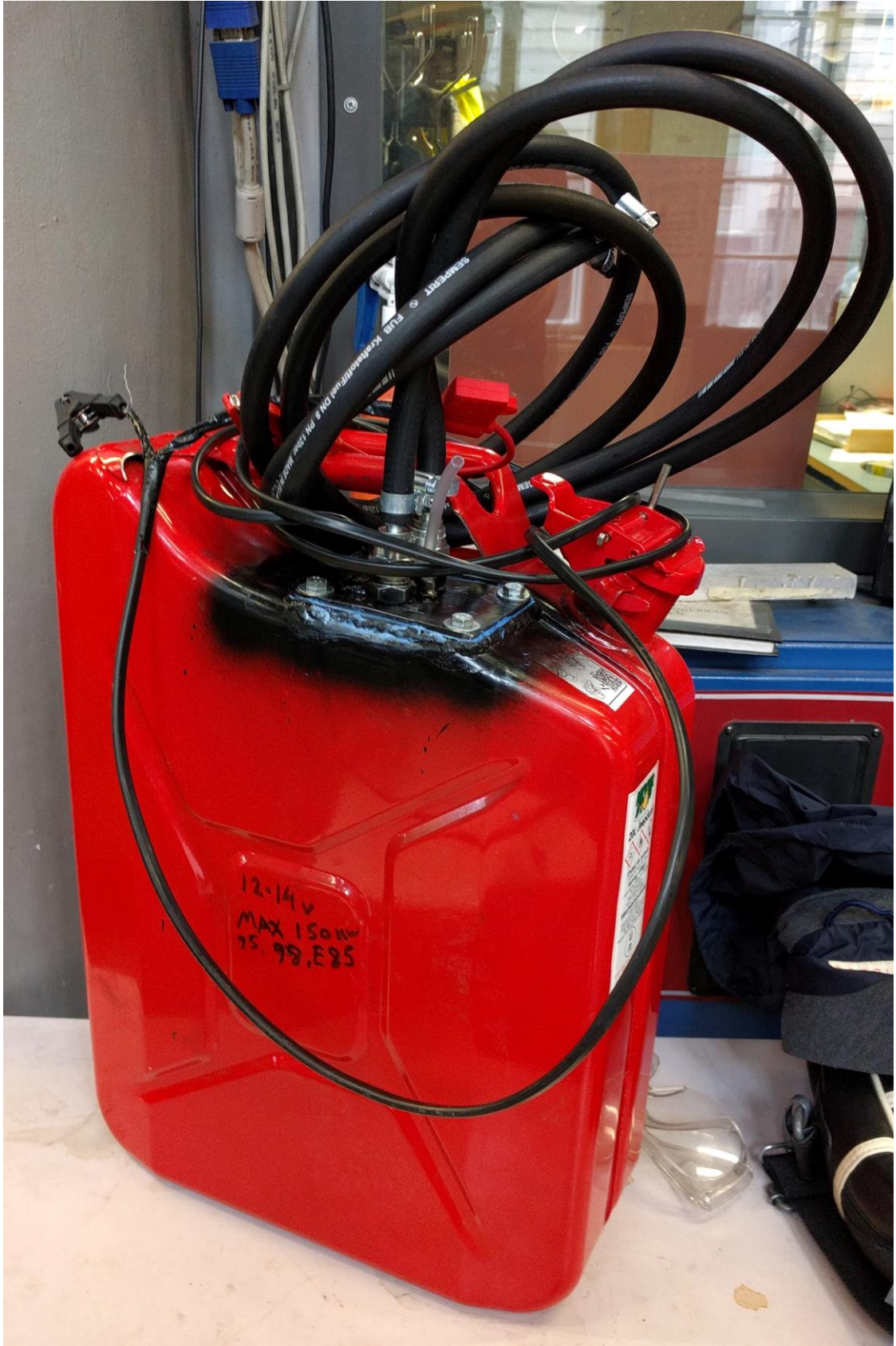
Kuva 4. Kulutusmittaukseen tehty ulkoinen polttoainesäiliö.
