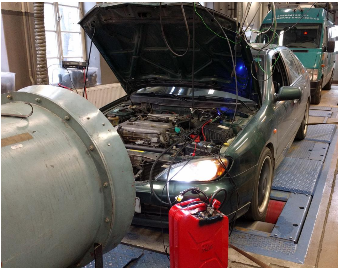
Kuva 5. Moottorin tehomittaus MAHA LPS 3000 PKW -alustadynamometrillä
