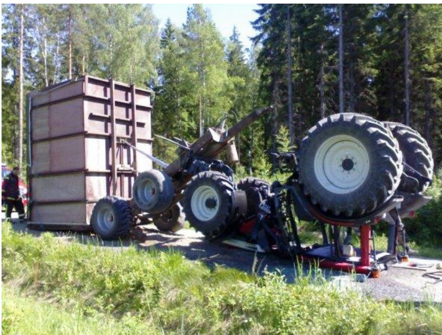
Bild 9. Truckgafflarna tog i vägen under vägtransport (Sjundeå FBK, 2007)
