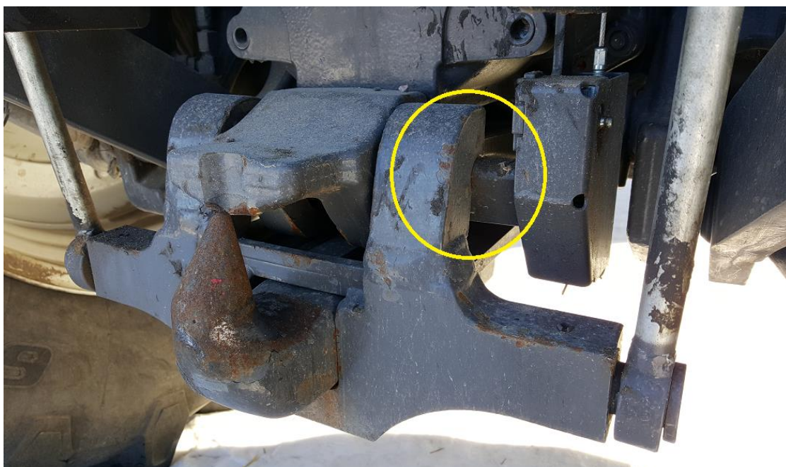
Bild 6. Dragkrokens vikt ligger på låsningsmekanismen
