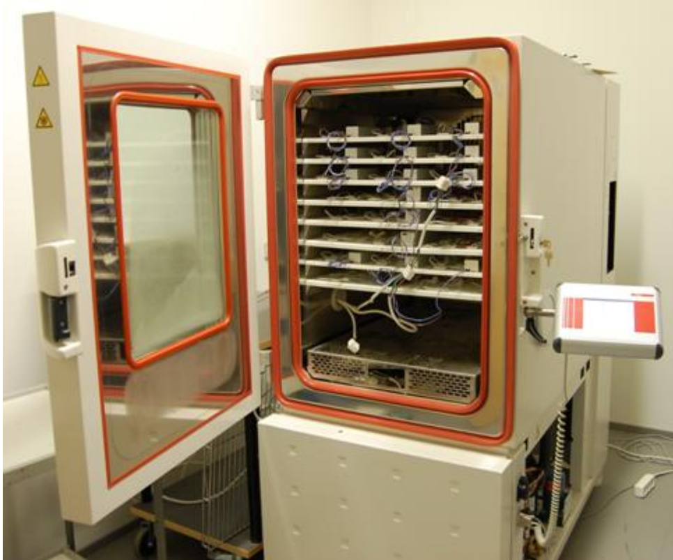
Kuva 11.5. Sääkaappi Vötsch VC 4034 ja testattavat kokoonpanot.
