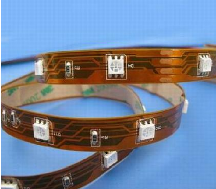
Kuva 7.1. Pintaliitostekniikalla toteutettu LED-nauha.
