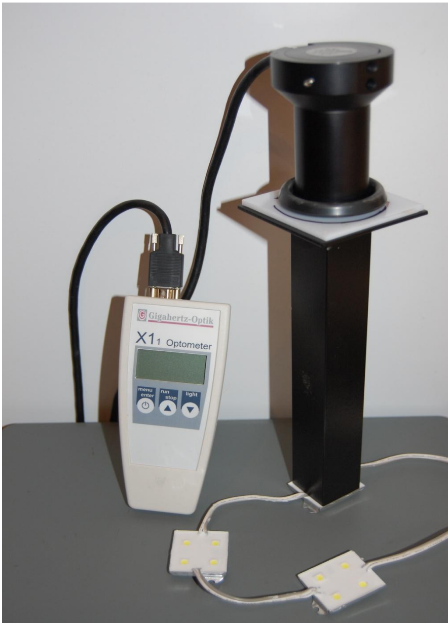
Kuva 11.2. LED-moduuli 1:n mittaukseen käytetty adapteri sekä Optomittari Gigahertz-Optik X1-1 ja sensori.
