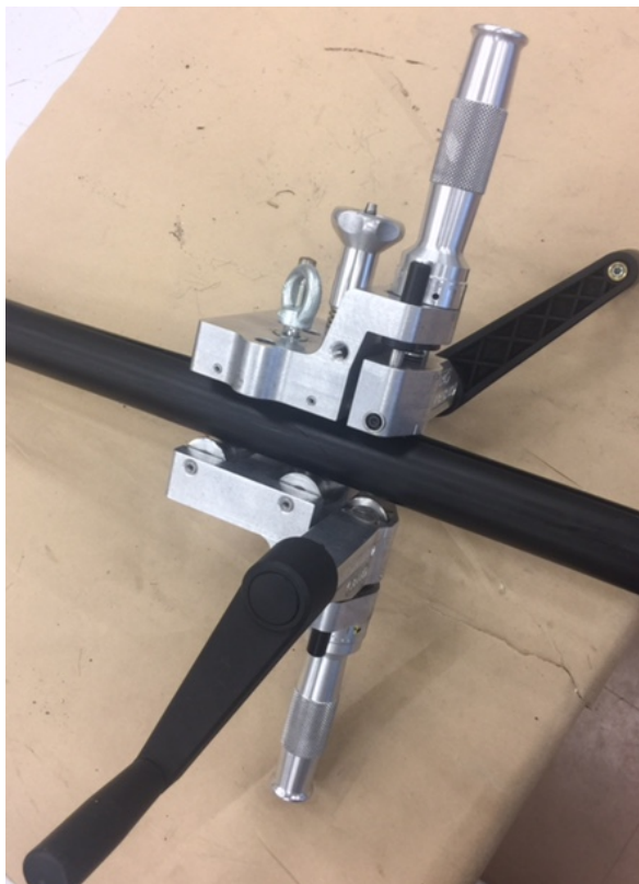
KUVA 3. ALROC -kaapelivaipan kuorimatyökalu (Kurttila, Kaapelivaipan kourimatyökalu (ALROC), 2017)
