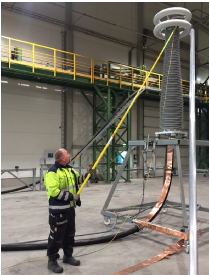
KUVA 6. Maadoitussauva toimintatilanteessa (Kurttila, Maadoitussauva toimintatilanteessa, 2017)
