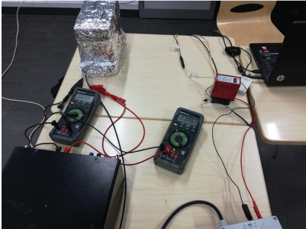
Kuvio 16. Testilaitteisto lämpövirtalevyjen luotettavuuden arvioimiseen
