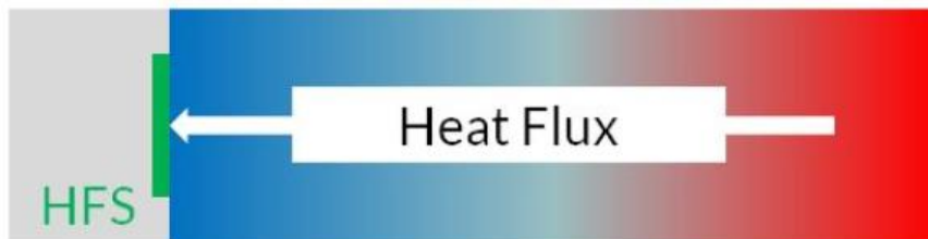
Kuvio 4. Suora lämpövuon mittaus lämpövirtalevyn avulla (Heat Flux Measurement... n.d.)
