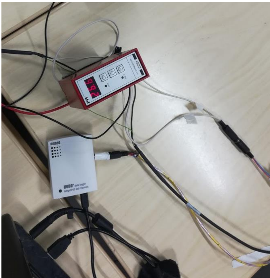
Kuvio 22. PR-2261 vahvistin liitettynä stereojohtimella HOBO-tiedonkeruulaitteeseen
