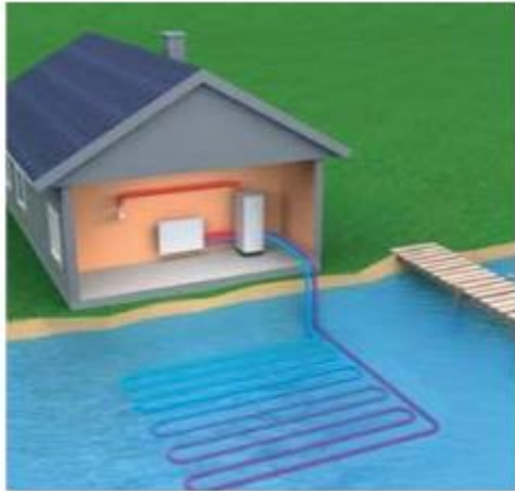
Kuvio 7. Vesistöön asennettava keruupiiri (Danfoss lämpöpumput pientaloille 2013, 6.)
