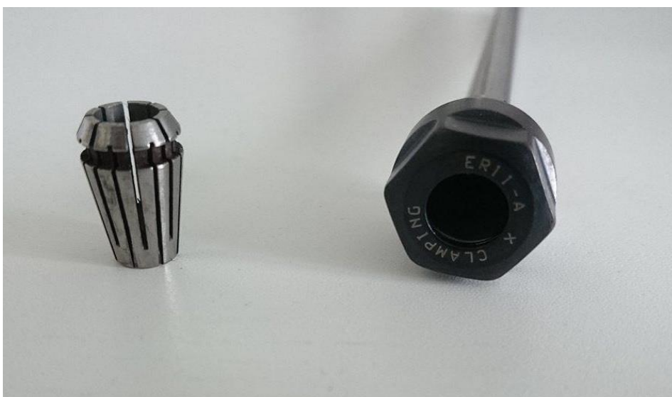
Kuva 24. Vasemmalla oleva ”jousiosa” tulee oikealla olevan mutterin sisään, ja mutteria kiristäessä jousiosa kiristyy kiinnitettävän akselin ympärille.
