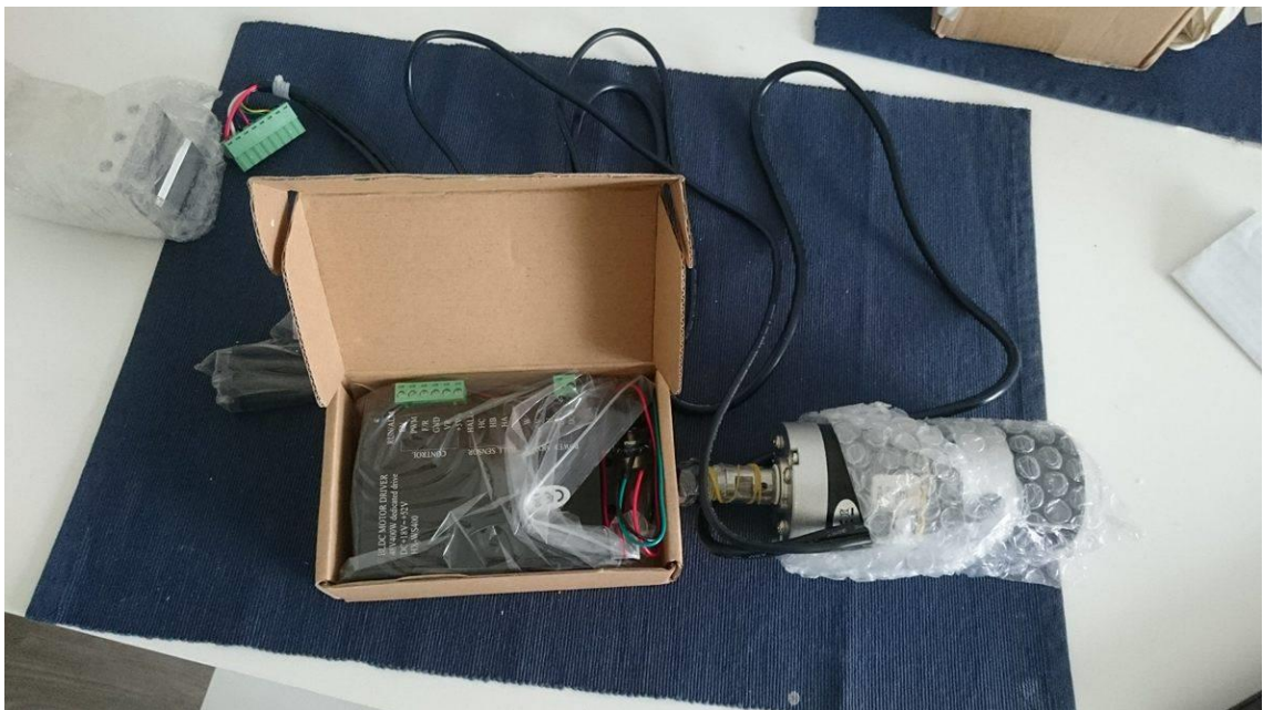
Kuva 1. Laitteessa käytettävä työkalu. Työstöterä tulee kiinni moottorin päässä olevaan ”ruuviin”.
