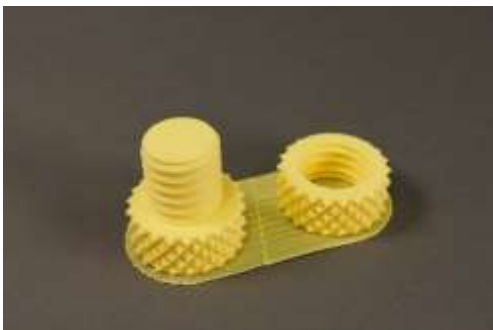
Figur 11. En raft för att eliminera elefantfötter.(Makerbot)
