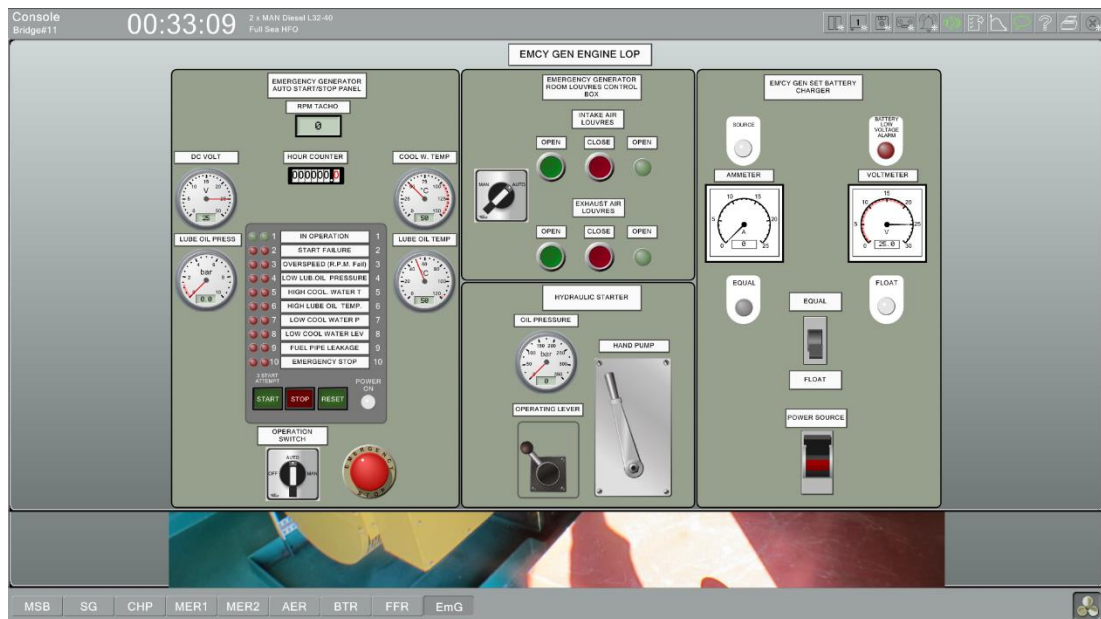
Kuva 2. Häätgeneraattorin käyttöpaneeli (Salminen)
