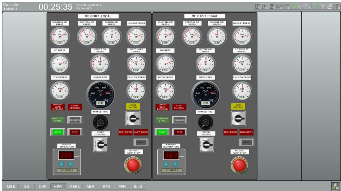
Kuva 28. Pääkoneiden paikalliskäyttöpaneelit (Salminen)
