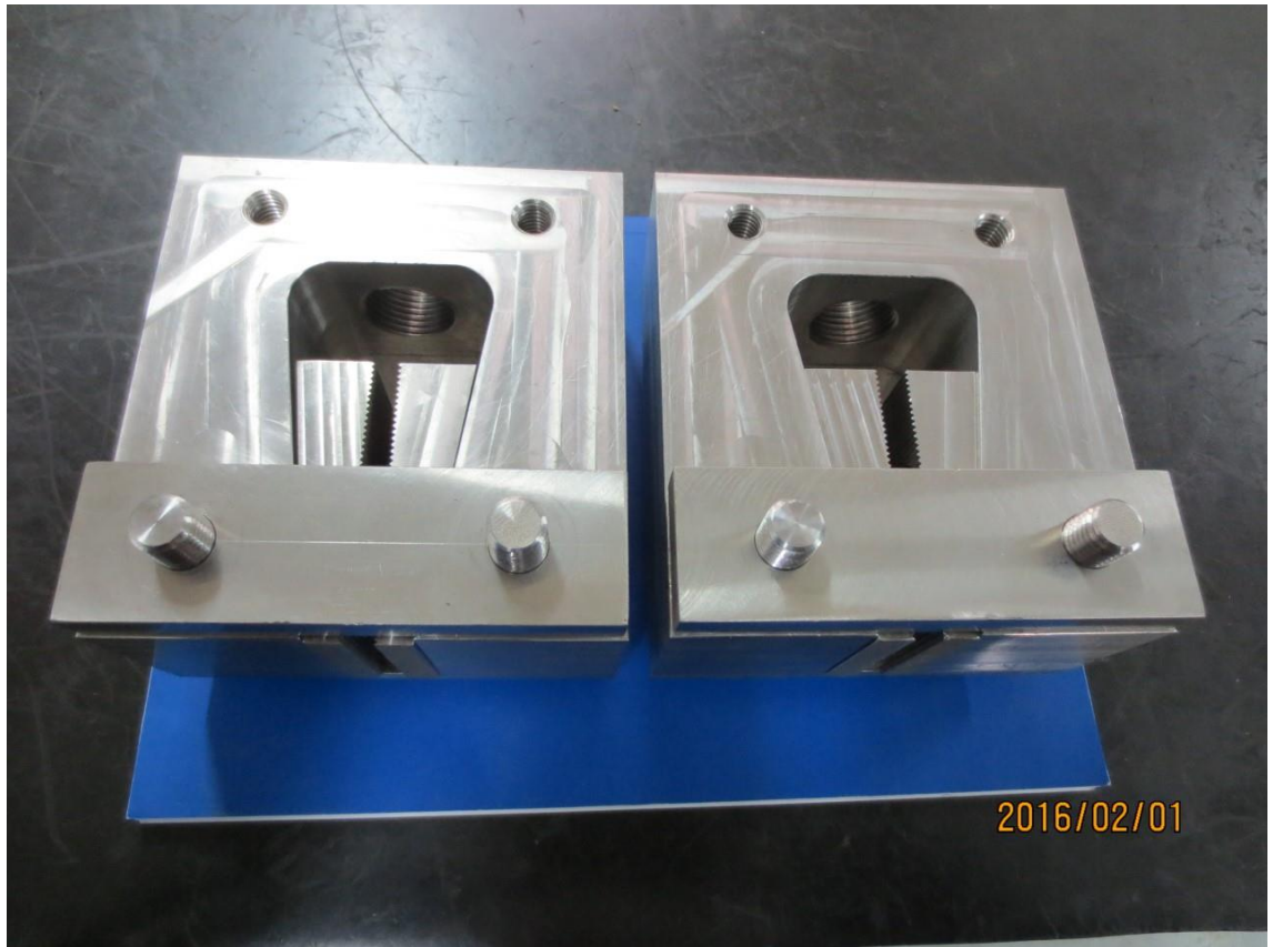
Appendix 8 8(20) Wedge fixture in use (Langeslag 2016.)
