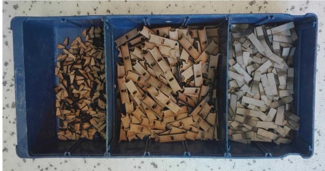
Kuva 109. Telojen osat valmiina liimaukseen.
