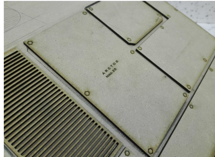
Kuva 115. Rasteroidut yksityiskohdat pienoismallin etulevyssä.
