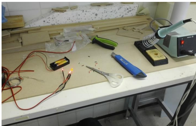
Kuva 94. Sivusuuntavalojen juottaminen valojärjestelmään.
