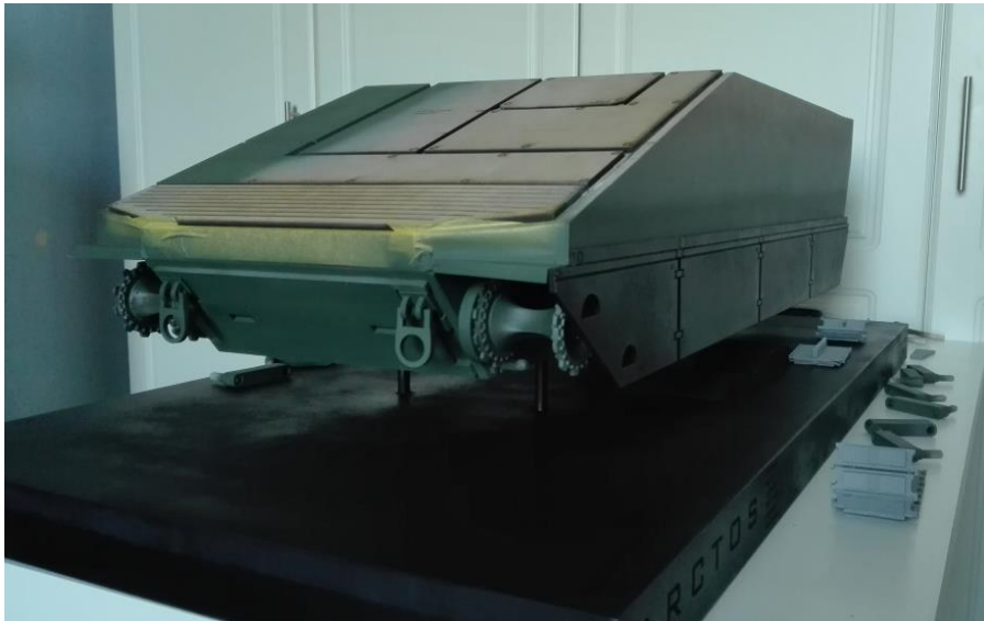
Kuva 135. Pienoismallin helmojen, alaetu- ja takapanssarin maalaus.
