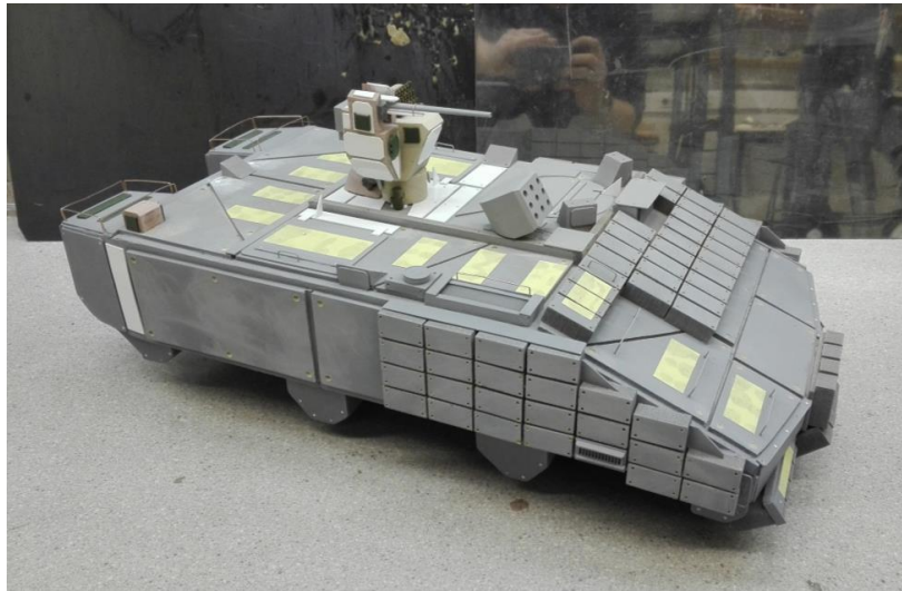
Kuva 36. Hiekkapaperista valmistetut kitkapinnat sekä magneeteilla toimivat liikkuvat järjestelmät.
