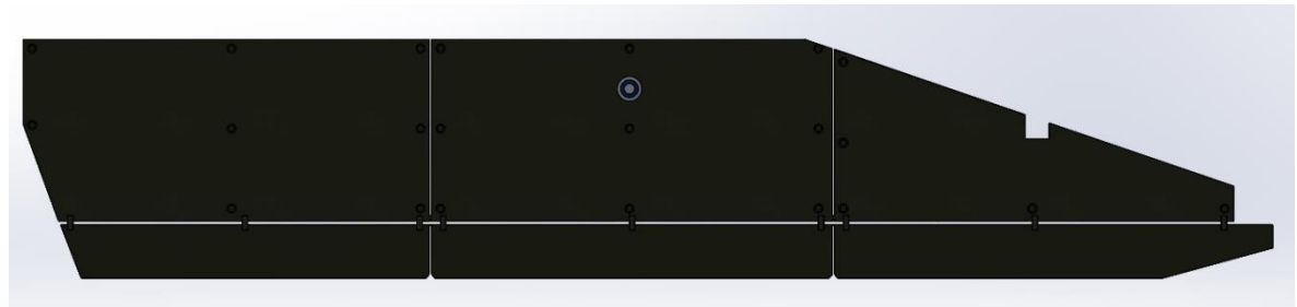
Kuva 72. Miehistönkuljetuspanssarivaunun kylkien lisäpanssarointi.
