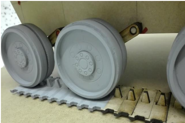
Kuva 117. Pohjamaalattu telapyörästä ja uudet laserleikatut jousitusvarret.
