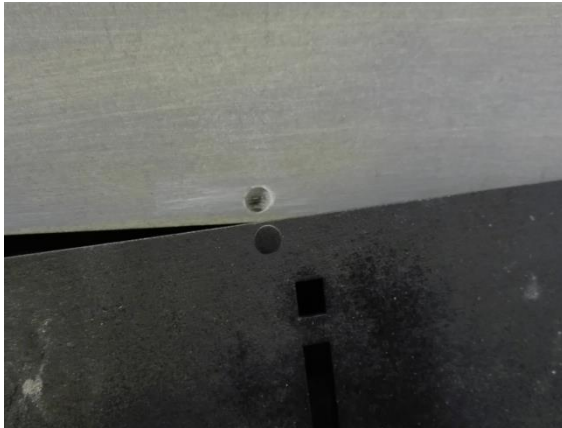
Kuva 125. Lokasuojan ja kylkilevyjen magneettikiinnityskohta.
