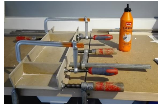
Kuva 78. Pohjan kylkilevyjen kiinnittäminen pohjalevyyn.
