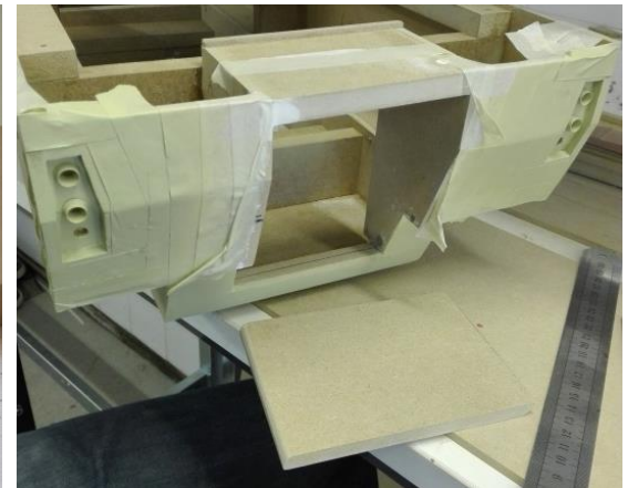
Kuva 93. Pienoismallin takaosan umpioiden spraykittäus.
