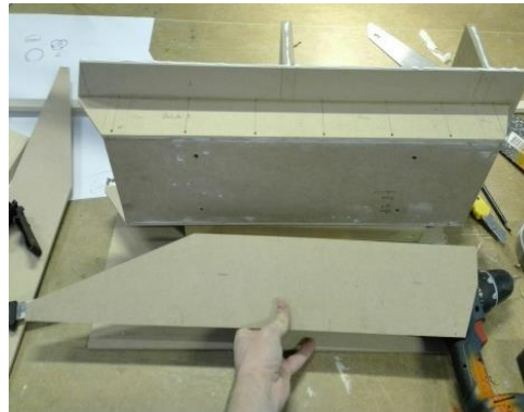
Kuva 83. Pohjarunkoon lisättävä MDF-levystä tehty kylkilevy.
