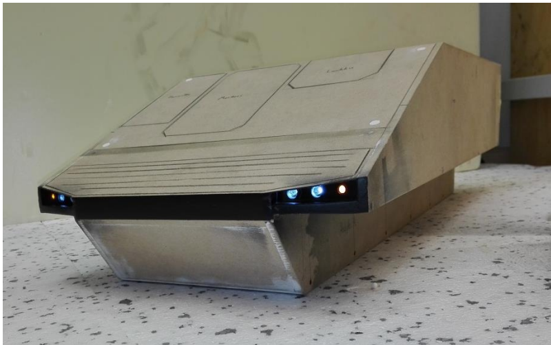
Kuva 97. Valmistunut pienoismallin etuosan valojärjestelmä.
