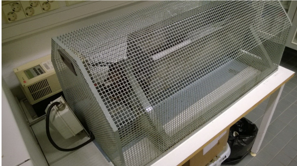
Kuva 9. Ravistelija. Vasemmalla käyttökytkin, jonka vieressä (suojaverkon sisällä) moottori sekä pyörivä metallilaatikko, johon ravisteltava näyte asetetaan. (Kuva: Mäkelä 2017.)
