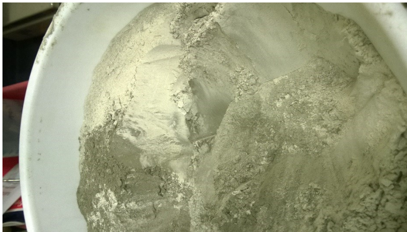
Kuva 6. Materiaalissa oli havaittavissa selvää epätasalaatuisuutta. (Kuva: Mäkelä 2016)
