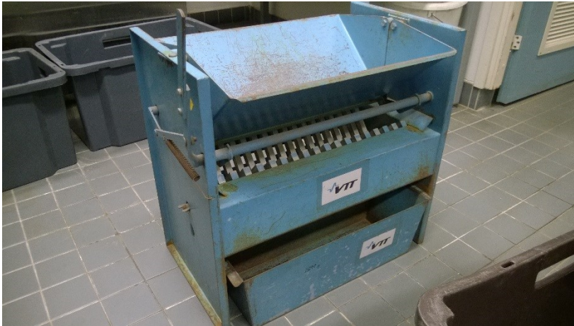
Kuva 7. Rännijakolaite. Materiaali ladataan jakajan yläosassa olevaan ränniin, joka aukeaa kääntämällä kuvassa laitteen vasemmalla reunalla olevaa vipua. Jaettava materiaali valuu laitteen alaosassa olevaan kahteen lokeroon laitteen keskellä olevien lovien läpi. (Kuva: Mäkelä 2016)
