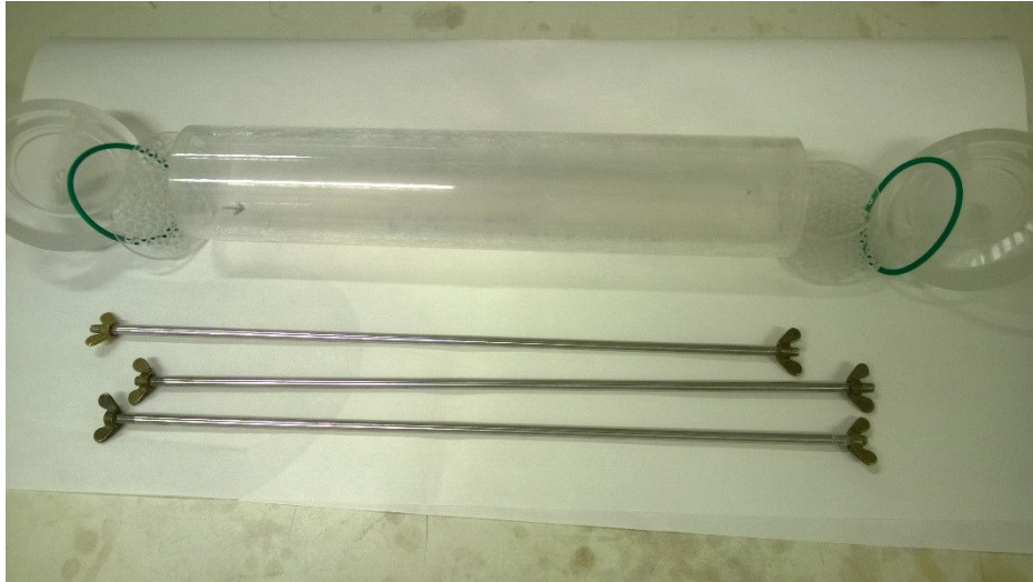
Kuva 13. Läpivirtauskolonnin osat. Kuvassa keskellä kolonni, sen päissä kahdet reikälevyt, kansien tiivisterenkaat ja uloimpana kannet. Etualalla metallitangot, joilla kolonni kasataan. (Kuva: Mäkelä 2017)
