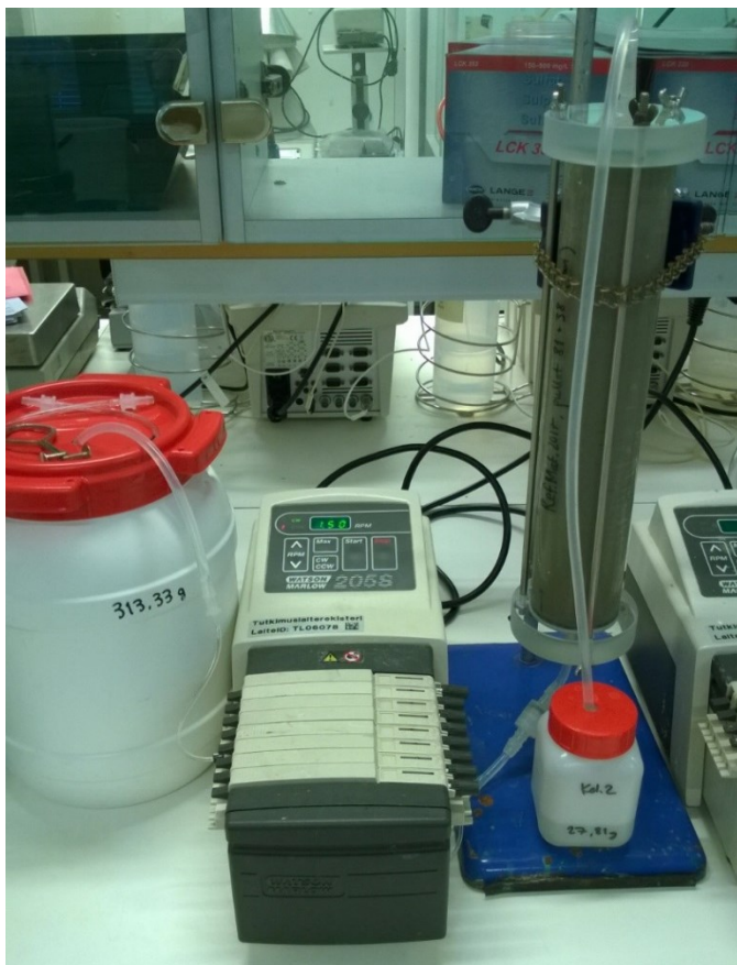
Kuva 14. Läpivirtaustestin koejärjestely. Vasemmalla ionivaihdetun veden astia, josta pumppu (keskellä) ottaa veden ja pumppaa sen alakautta oikealla olevan kolonnin läpi. Läpi virrannut vesi kerätään fraktioittain (pullo kolonnin edessä). (Kuva: Mäkelä 2017)
