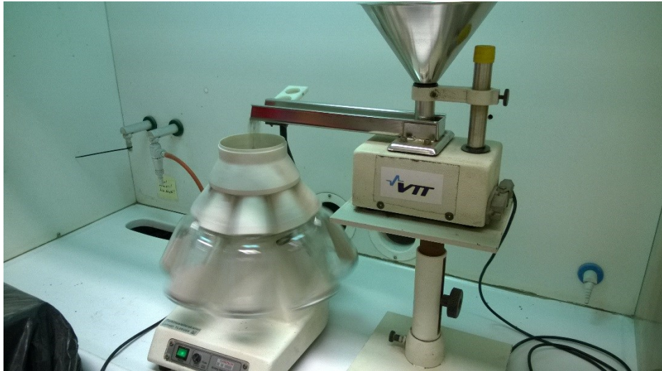
Kuva 8. Pyörivä jakaja. Materiaali valuu kuvassa oikealla olevan tärstimen yläosassa olevasta suppilosta kuljettimelle, jota pitkin se kulkeutuu pyöriviin pulloihin. (Kuva: Mäkelä 2016)
