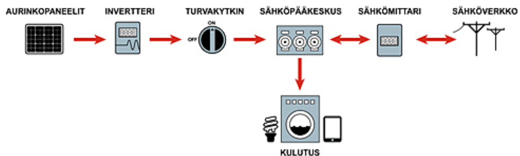
Kuva 4. Sähköverkkoon liitetyn aurinkosähköjärjestelmän periaatekuva [19].
