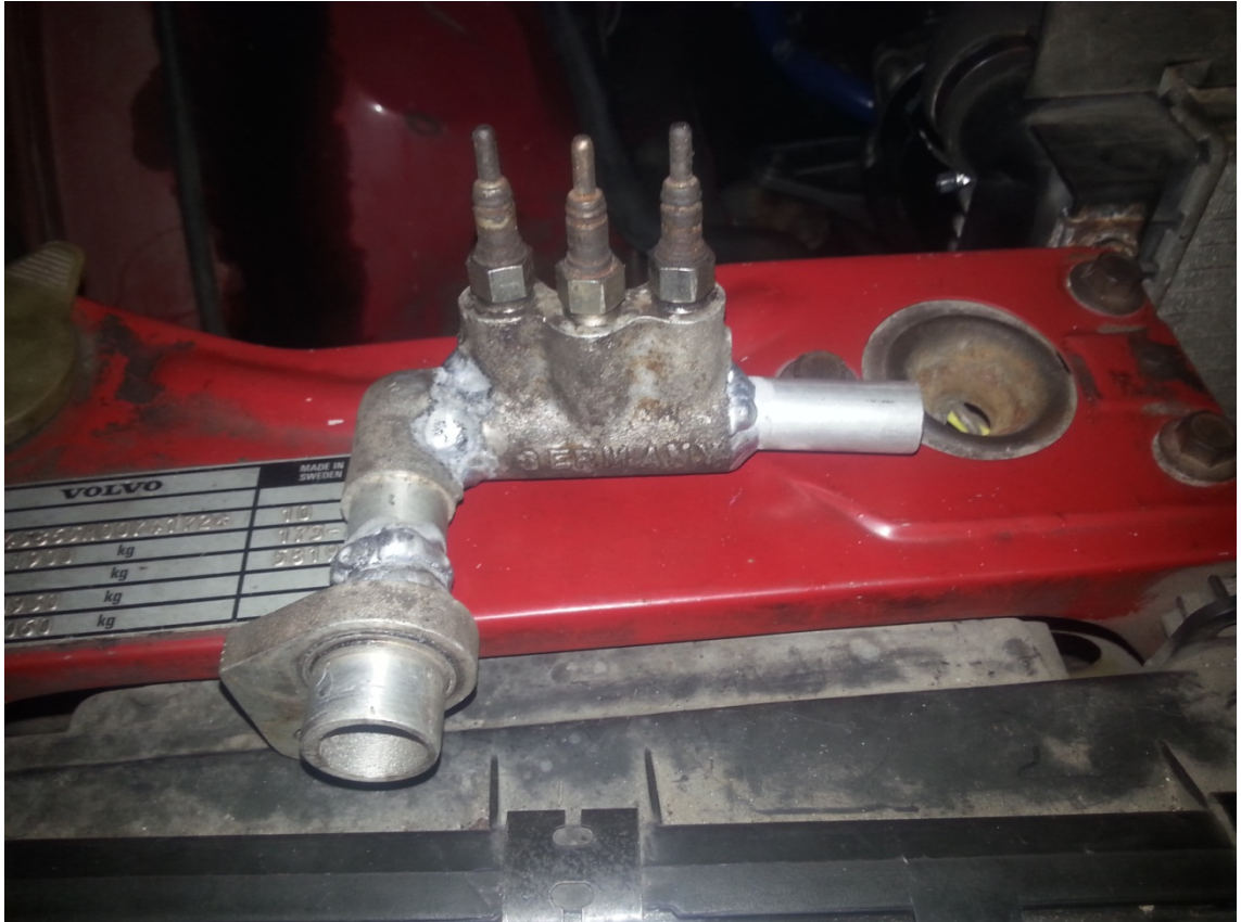
Kuva 21. Kannen takapäähän muokattu vesiletkunippa hehkutulppineen.
