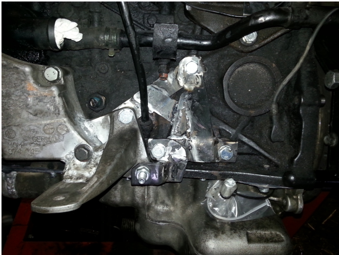
Kuva 12. Vasen moottorin kannakkeen tukirauta.
