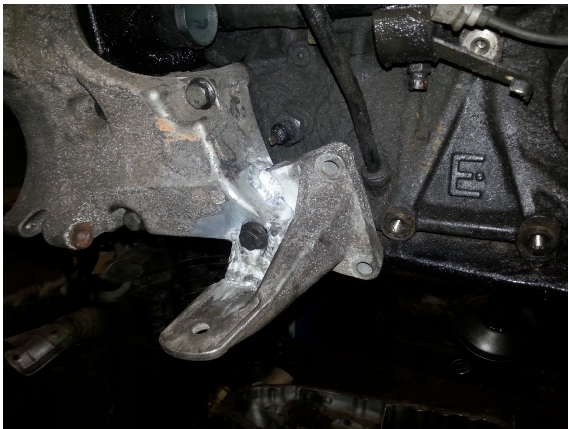
Kuva 11. Apulaitetelineeseen kiinni hitsattu vasen moottorin kannake.
