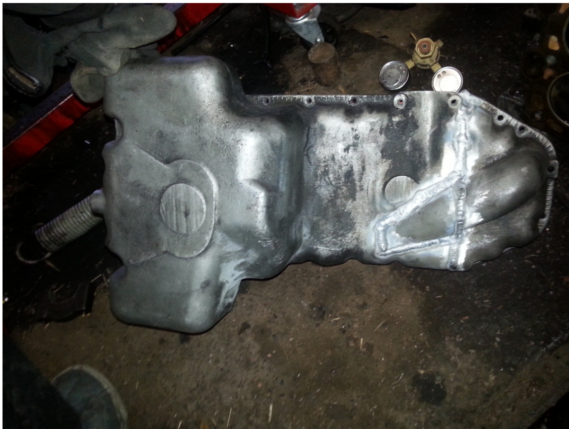
Kuva 9. D24 -moottorin öljypohja muokattuna.
