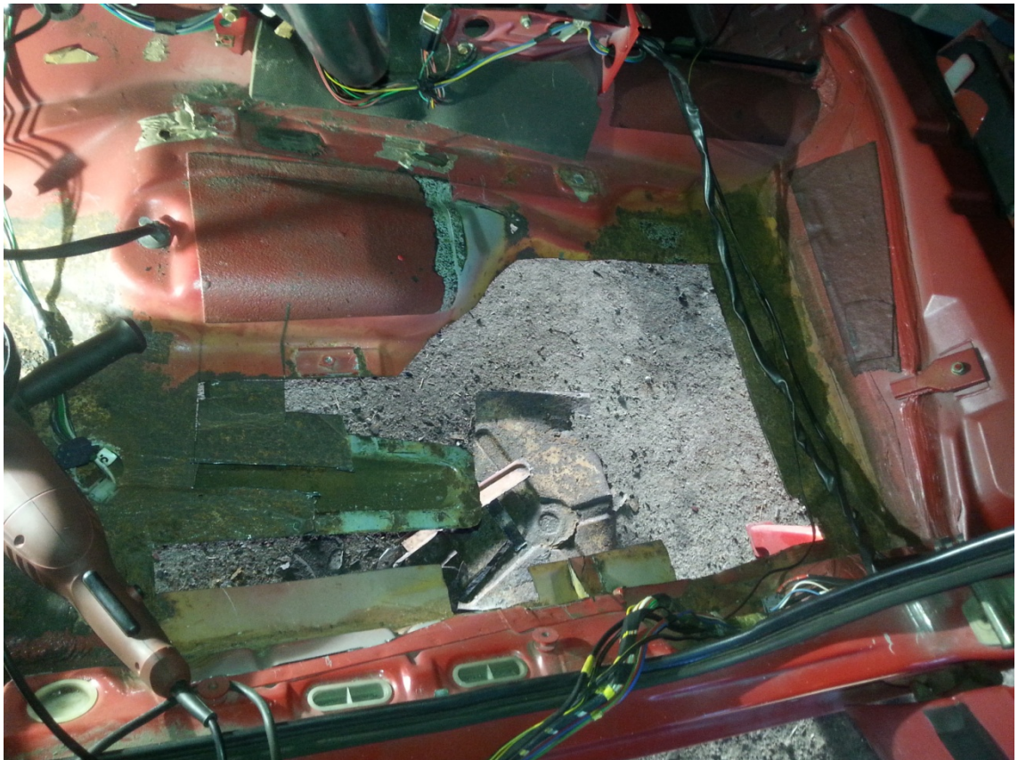
Kuva 5. Takajalkatilaan syntyi suurehko aukko.
