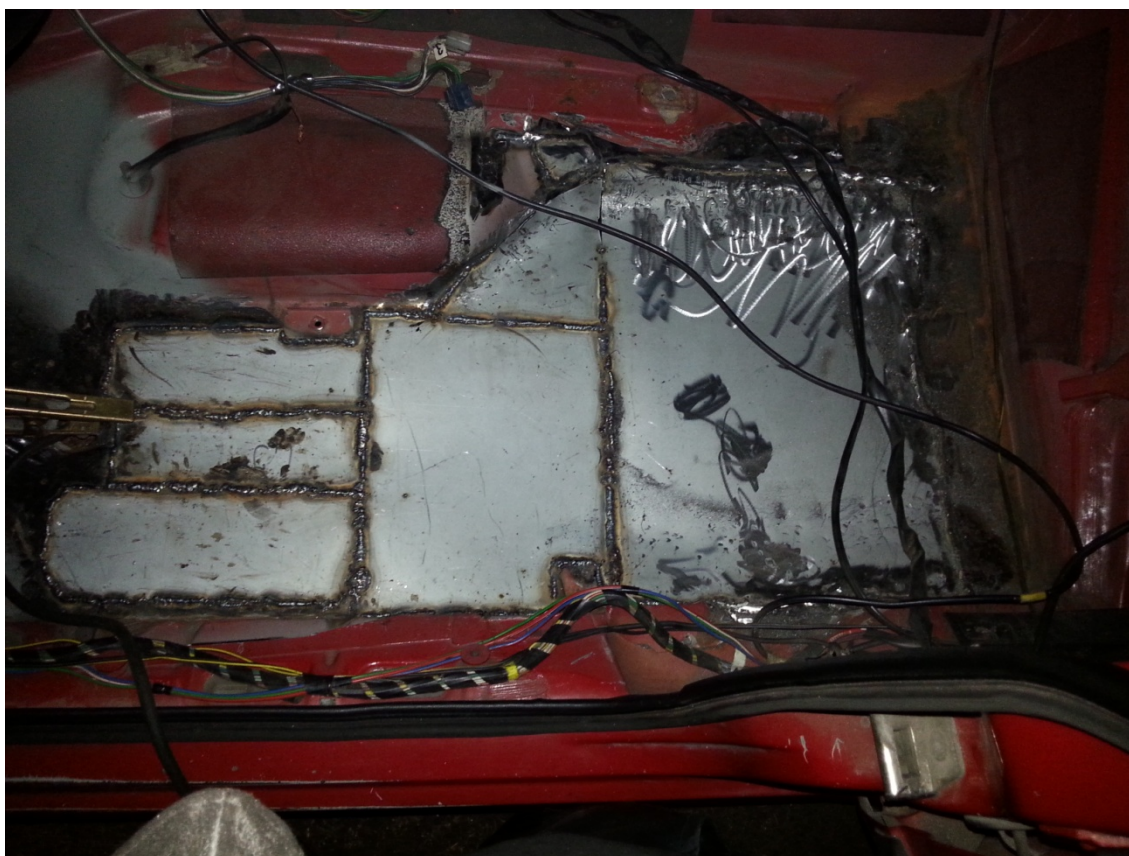
Kuva 6. Uuden pellin hitsaamista takajalkatilaan.
