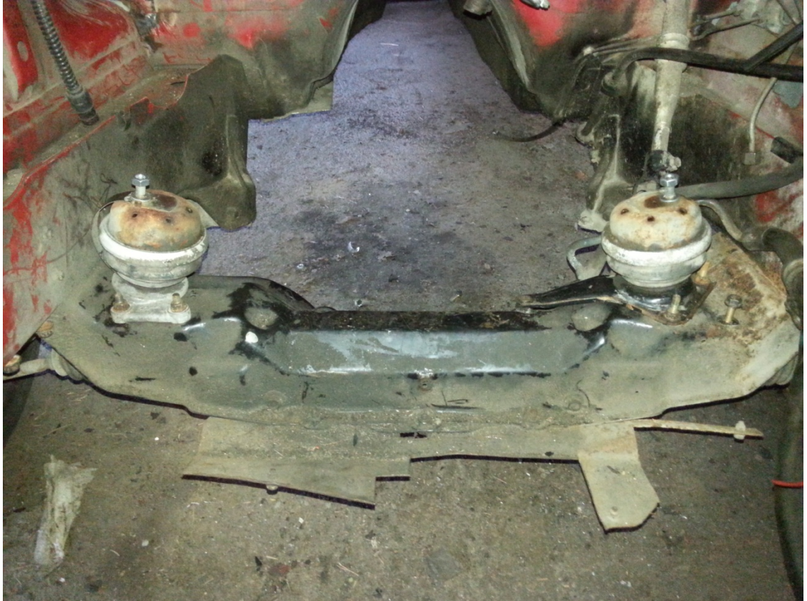
Kuva 14. D24 -moottorin kannatintyynyt korvineen paikoillaan.
