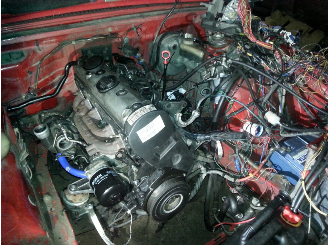
Kuva 19. Moottorin johtosarja kytkettynä koekäyttöä varten.
