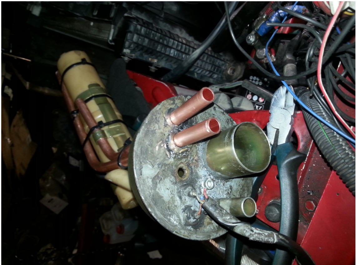
Kuva 22. Tankkivarusteen suuremmat kupariset polttoaineputket.
