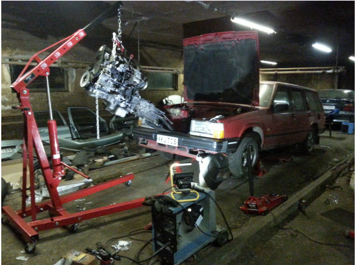
Kuva 18. Moottorin koesovitus autoon.
