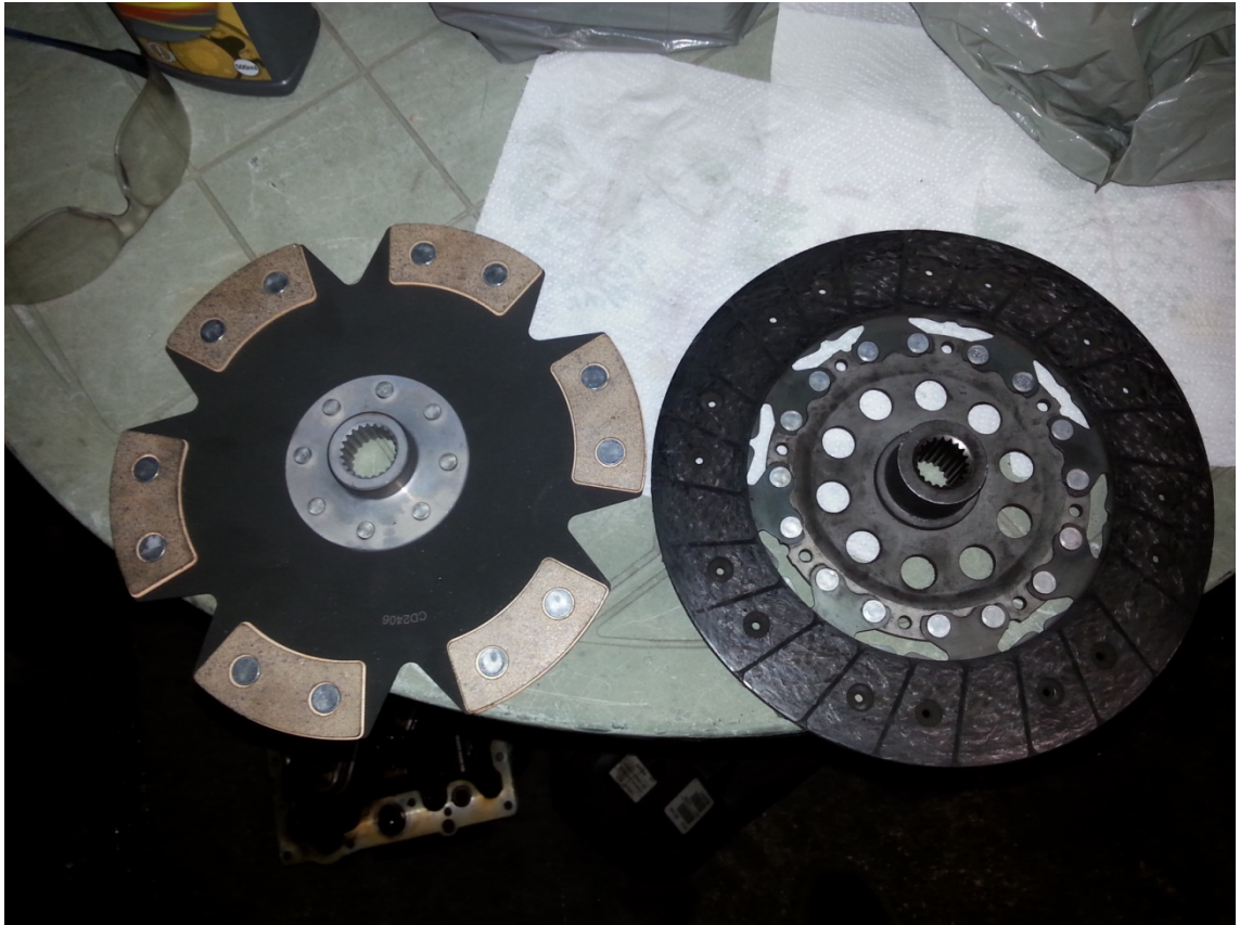
Kuva 15. Sinterilevy ja moottorin alkuperäinen kytkinlevy.
