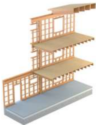
Kuvio 5. Pilari-palkki rakennejärjestelmä
