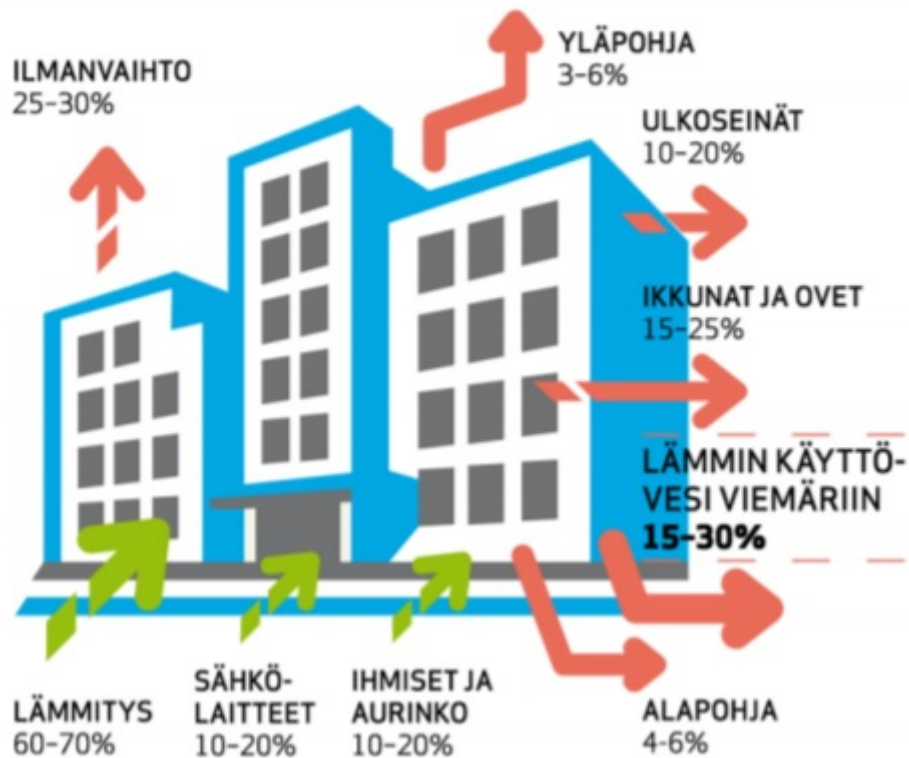
Kuva 5: Lämpötase kerrostalossa
