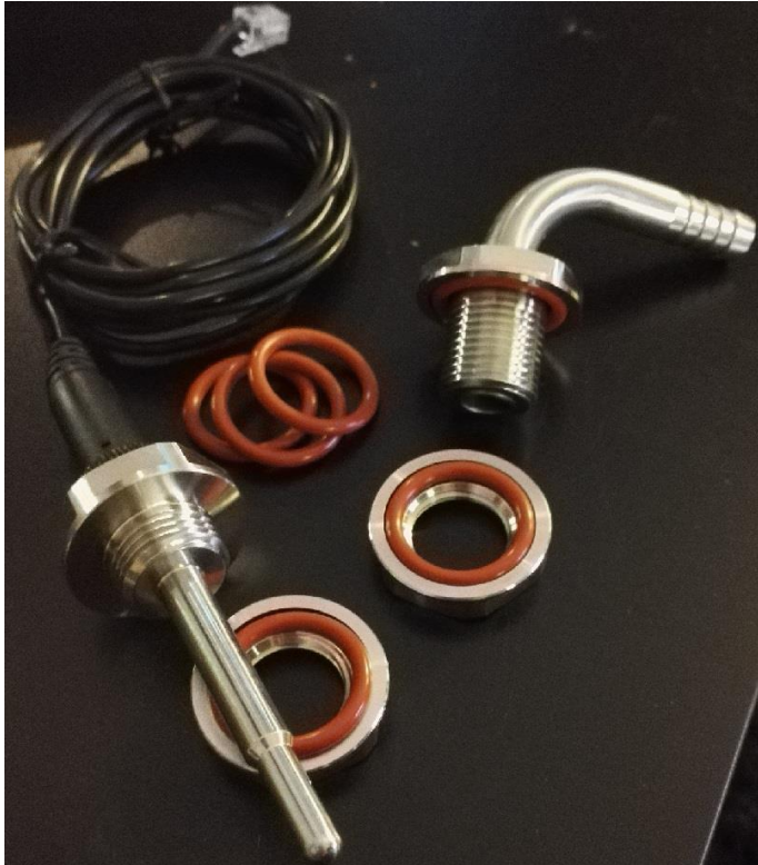
Kuva 4. Lämpötila-anturi ja läpivienti pumpulle
