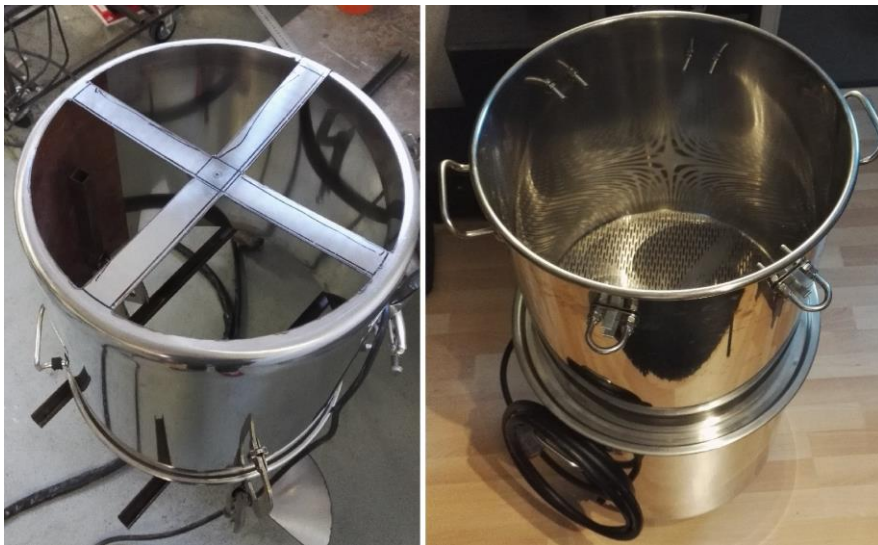
Kuva 1. Vasemmalla mäskäyskattilan pohja plasmaleikkauksen jälkeen. Oikealla keittokattila, jonka päällä mäskäyskattila pysyy apukannen avulla
