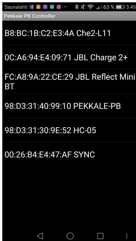
Kuva 26. Bluetooth-laitteen valintaikkuna. Ikkunassa näkyy kaikki käytössä olevan Android-laitteen muodostamat Bluetooth-laitteparit
