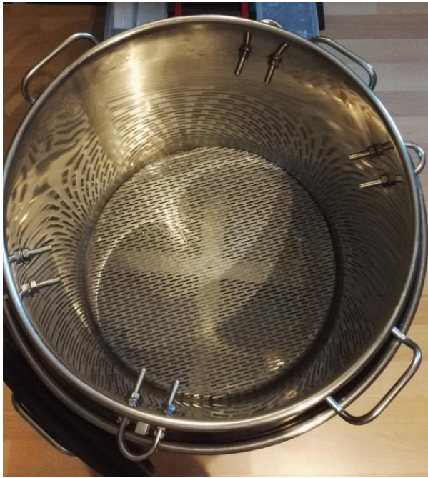
Kuva 2. Mäskäyskattila keittokattilan sisällä tukien varassa
