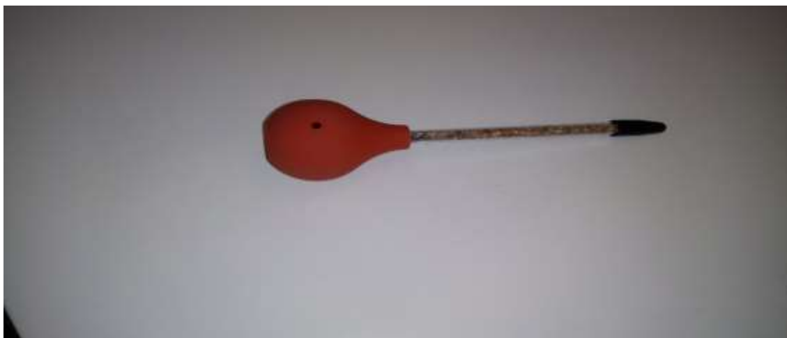
KUVA 21. Merkkisavuampulli (kuva: Heikki Loukusa 12.12.2016)
