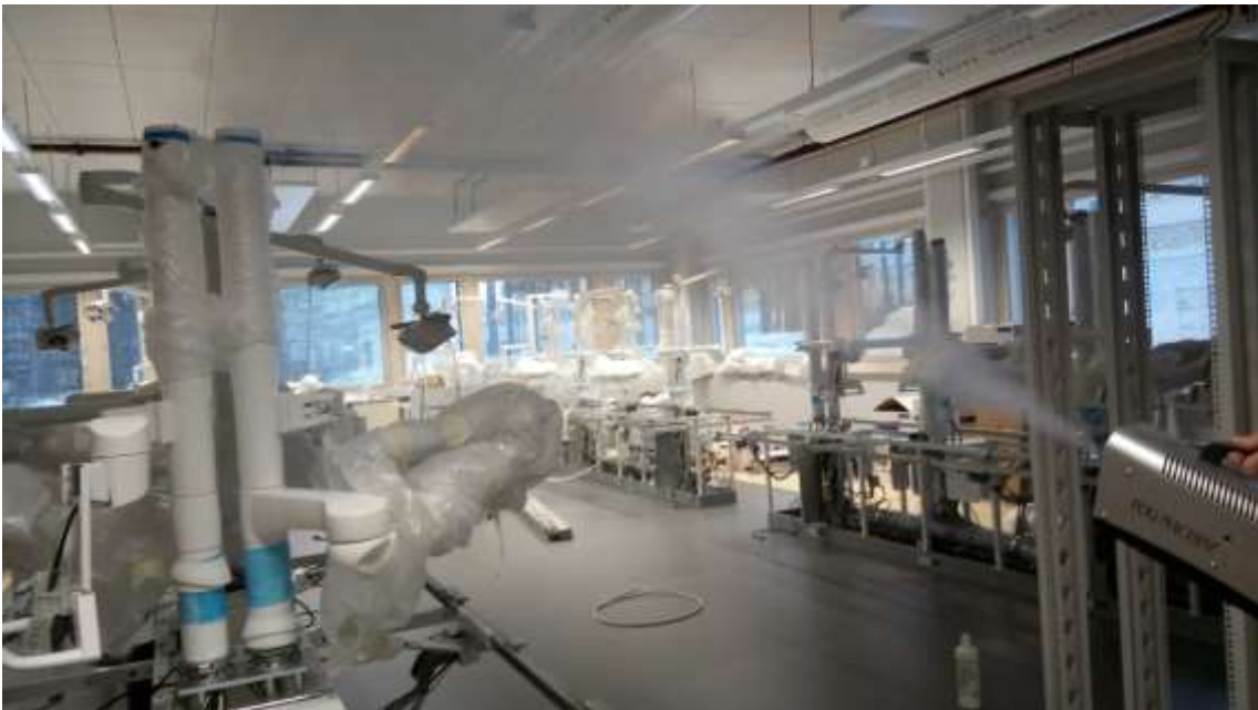
Kuva 24. Savukoe laboratoriotilassa (kuva: Heikki Loukusa 12.12.2016)
