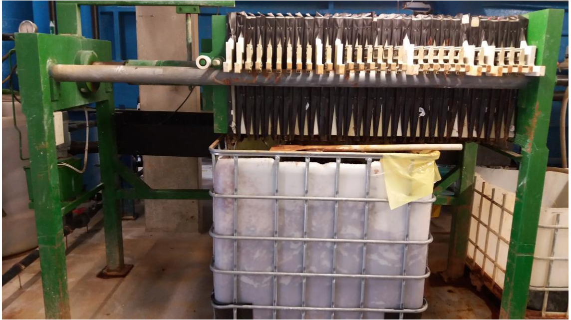
KUVA 6. Suotopuristin (Kuva: Kalle Koikkalainen 2017)
