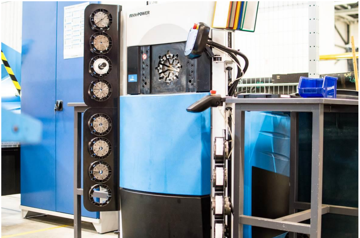
KUVA 5. Letkutuotannossa käytettävä puristin ja solussa käytettävät leuat.
