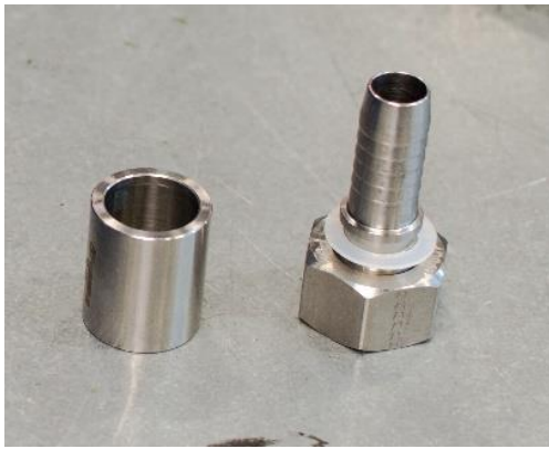
KUVA 8. Kuvassa oikealla on liitin ja vasemmalla siihen sopiva holkki.
