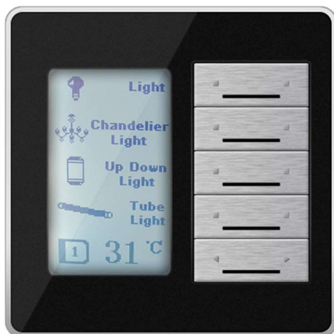
KUVA 11. DDP-ohjauspaneeli. Paneelin eri sivuja selataan alimmalla painikkeella ja näytön kuvakkeiden osoittamia toimintoja hallitaan neljällä muulla painikkeella. (Smart Group (ä) 2016, 33).
