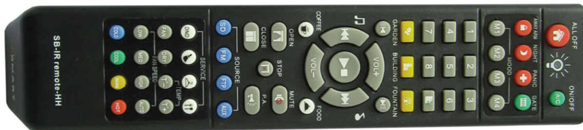
KUVA 12. Smart-BUS-järjestelmän kaukosäädin (Smart Group (ä) 2016, 40).
