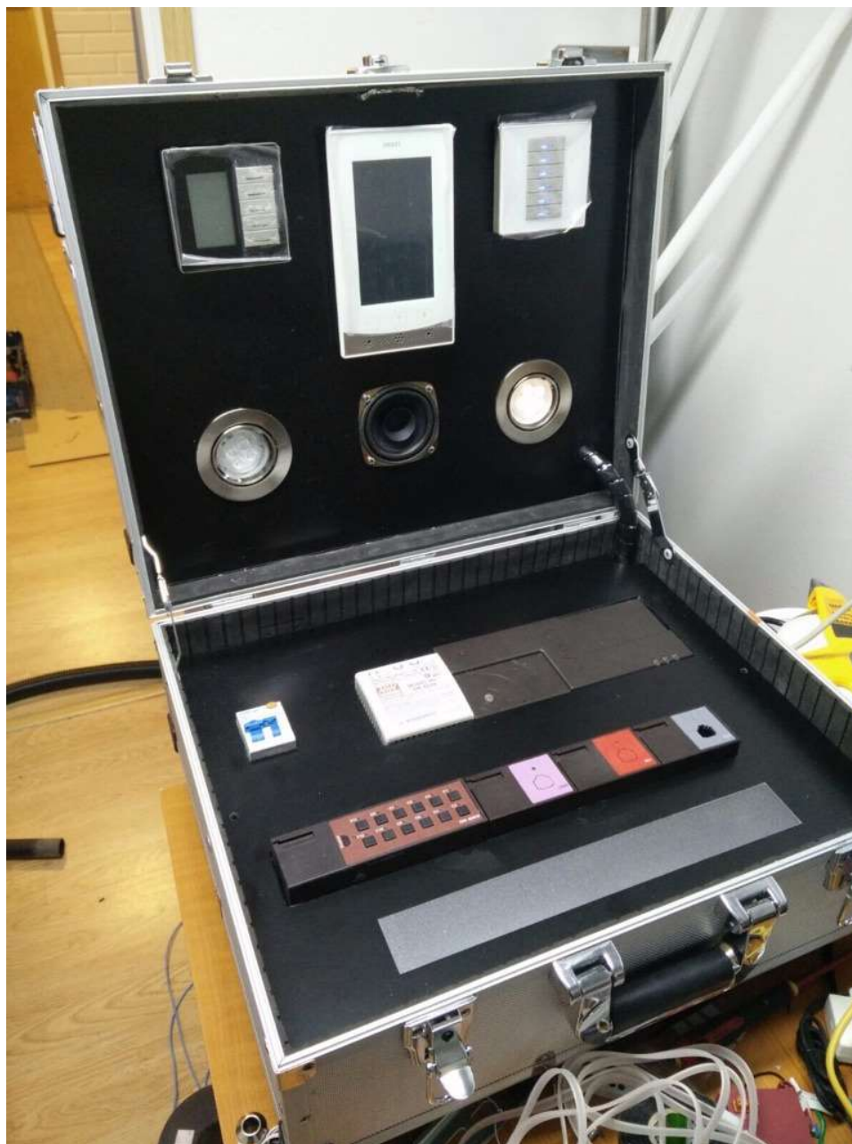
KUVA 14. Smart-BUS-järjestelmällä toteutettu siirrettävä demolaitteisto.
