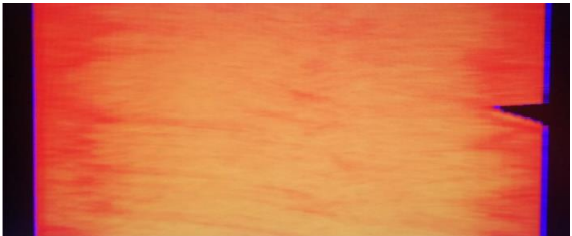
Kuva 14. IR-kameran havainto muoviloikasta (Muhonen P, Oppareiden laatukoulutus)
