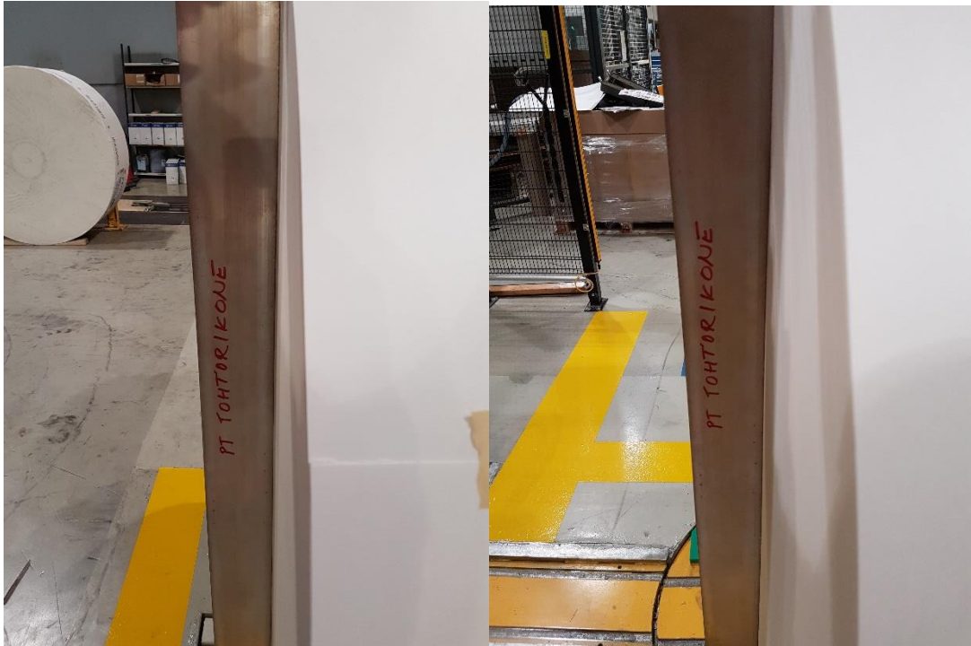
Patapäisyys heittojen korjauksen jälkeen
