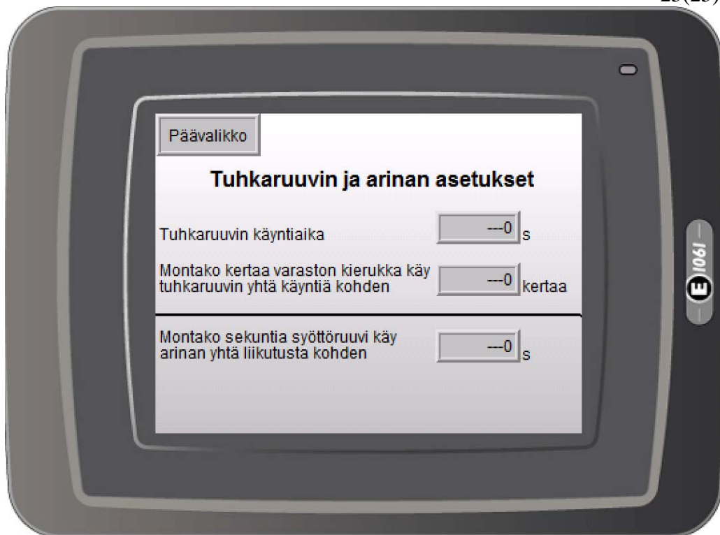
KUVA 14. Hallintapaneelin valikko tuhkaruuvien ja arinan asetuksille
