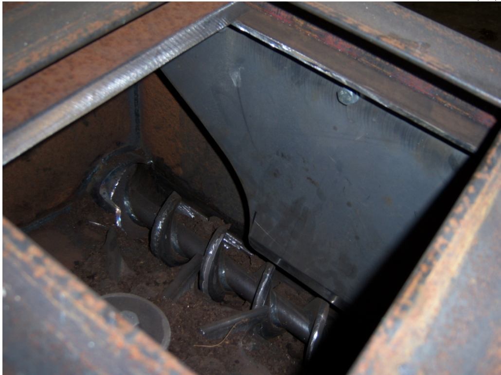
KUVA 4. Polttoaineen syöttöruuvi syöttölaatikon sisällä
