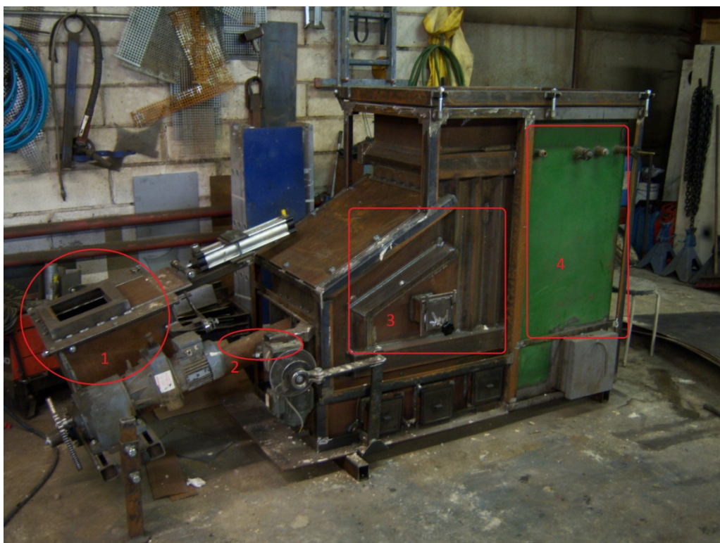
KUVA 2. Automatisoitava kattila ilman lämpöeristeitä
