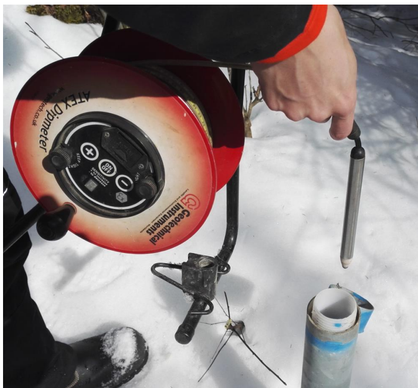
Kuva 1. Pohjaveden mittaus käsimittalaitteella havaintoputkesta
