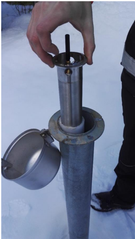
Kuva 9. Mittalaitteiston asennus pohjavesiputkeen
