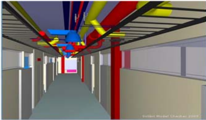
Kuvio 9. Solibri Model Checker -ohjelman yhdistelmämallitarkastelu. /15/
