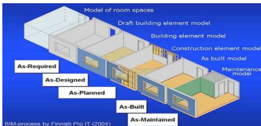
Kuvio 1. Tuotetietomallin (BIM) kehittyminen rakennusprojektin aikana. /15/
