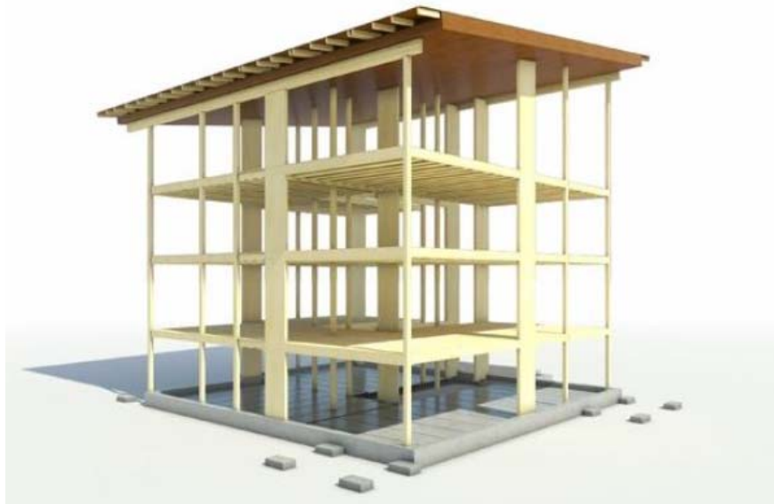
KUVA 16. Pilaripalkki rakenteinen kerrostalon runko (Metsä Wood 2013, 9.)
