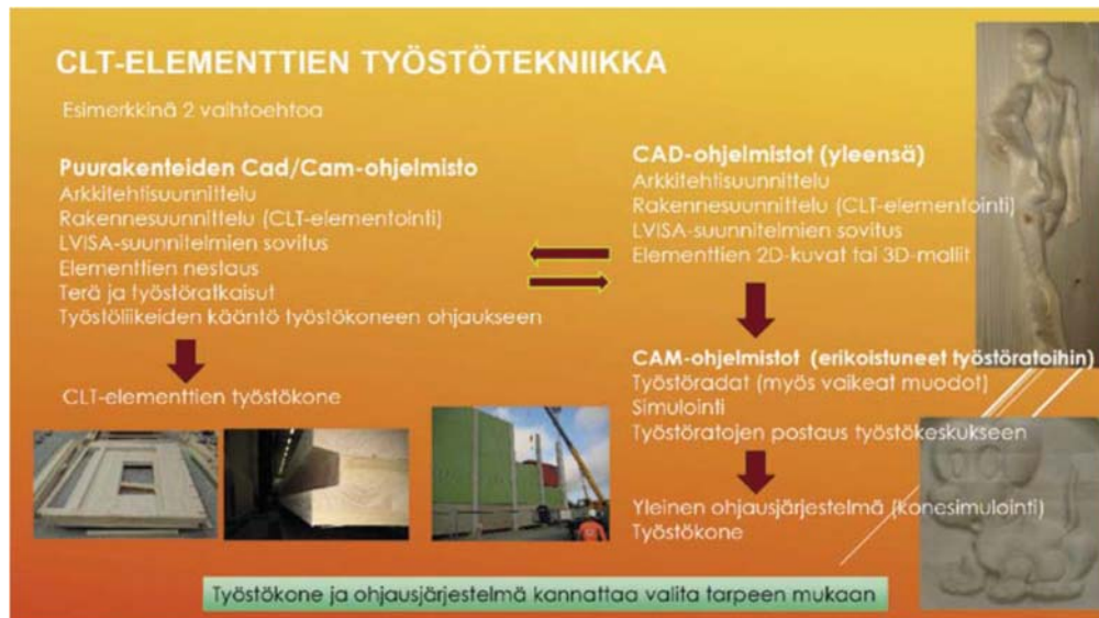
KUVA 40. CLT -elementtien työstöprosessi ja tietomallinnuksen liittyminen prosessiin (Sirkka ja Pirinen 2017, 24) (Yliniemi 2015.)
