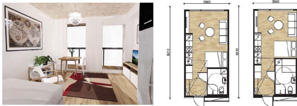
KUVA 39. Tilaelementin sisustus ja pohjapiirustus (Elementti Sampo 2016.)
