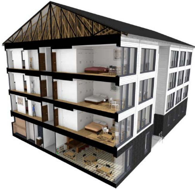
KUVA 38. Elementti Sampo Oy:n Suomi kerrostalojärjestelmä (Elementti Sampo 2016.)
