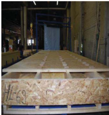
KUVA 36. Puumeran välipohjalementti elementtitehtaalla (Sorsa, 2015, 18.)
