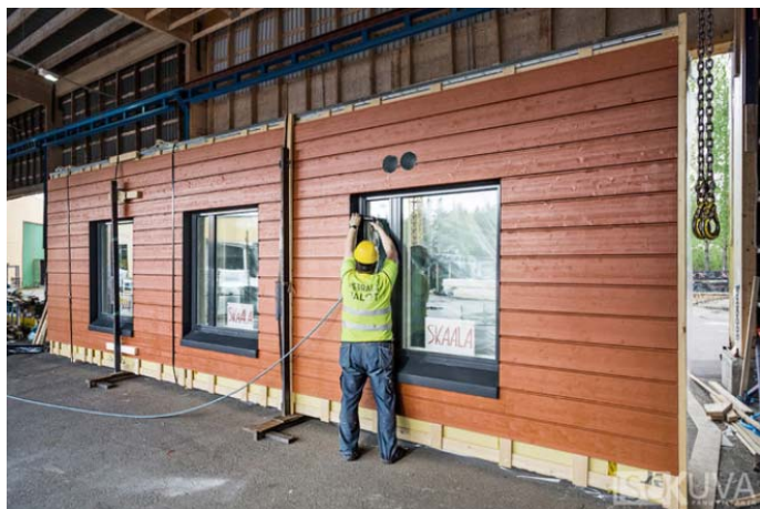
KUVA 33. PuuMera suurelementin valmistus (PuuMera 2016a.)
