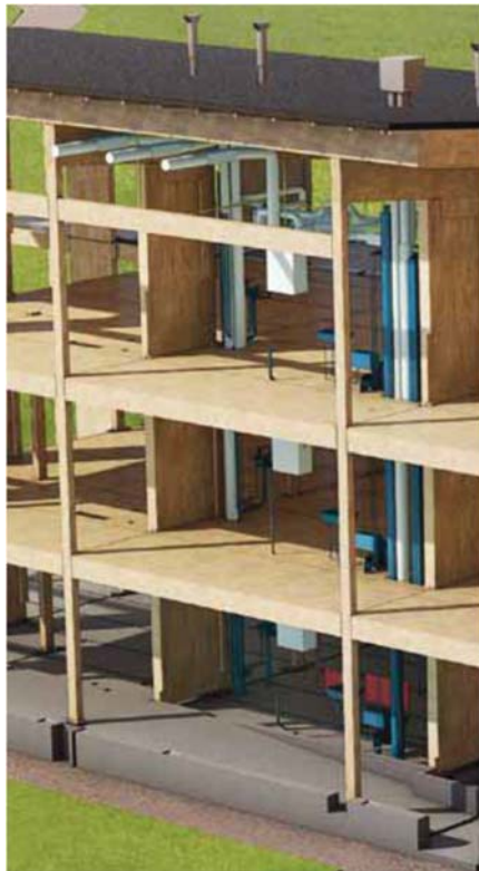
KUVA 30. Talotekniset asennukset runkovaiheessa (Metsä-Wood 2013, 4.)
