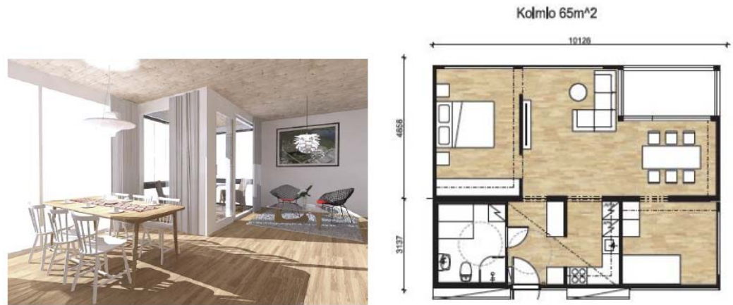
KUVA 15. Tilaelementtien pohjapiirustus ja tilaelementtien sisutus (Elementti Sampo 2016.)
