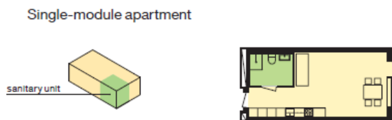
KUVA 25. Pienimpien asuntojen tilaelementti (Stora-Enso 2016a, 14.)
