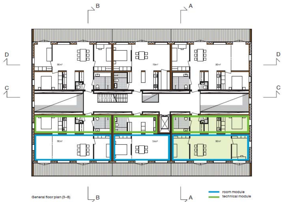
KUVA 24. Stora-Enson tilaelementtijärjestelmä (Stora-Enso 2016a, 15.)
