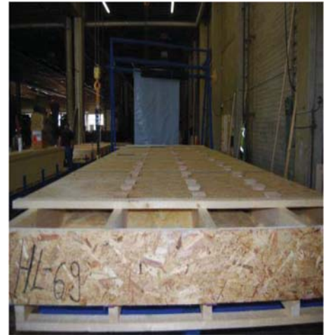
KUVA 21. Liimapuu ja levyrakenteinen välipohjaelementti (Sorsa 2015, 18.)
