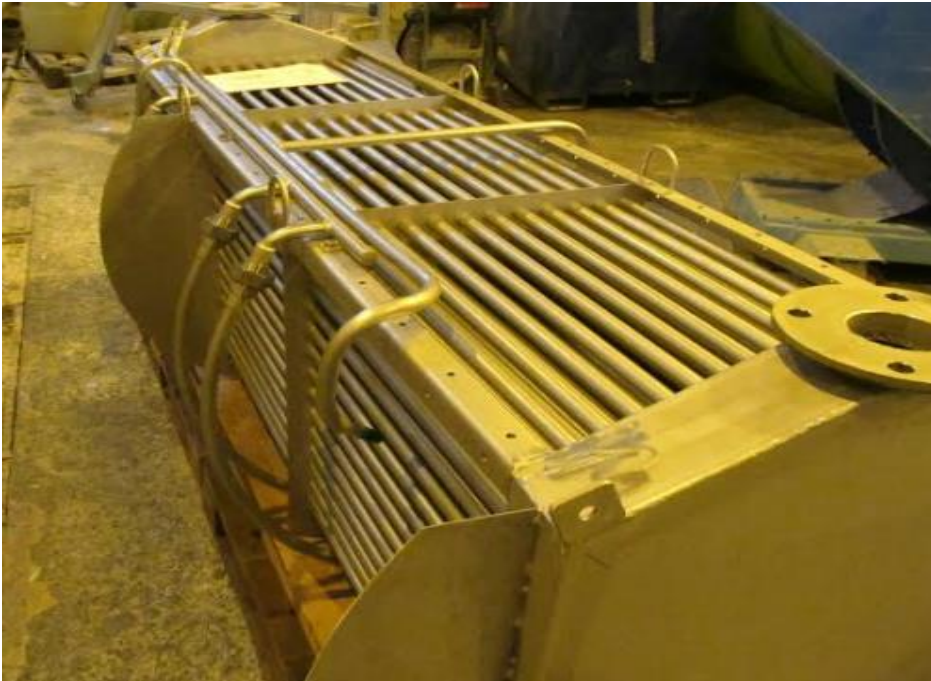
KUVA 8 Ilmastinputket ja painehuuhteluputket lämmönsiirtoputkistossa
