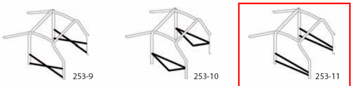
KUVIO 31. Oviristikko merkitty mustalla värillä; malli merkitty punaisella neliöllä. (AKK sääntökirja 2010. [Viitattu 10.1.2010]).
