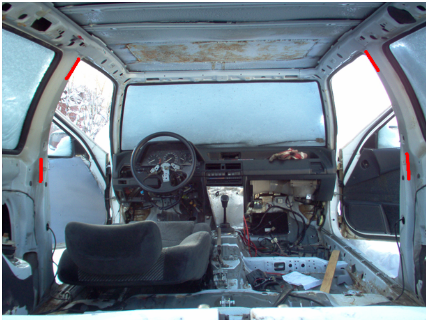
KUVIO 44. Pääkaaren kiinnityspisteet ovipilarin ylä- ja alaosaan on merkitty punaisella.
