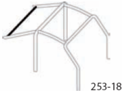
KUVIO 32. Lisätuki turvavöiden kiinnittämiseen merkitty mustalla värillä. (AKK sääntökirja 2010. [Viitattu 10.1.2010]).
