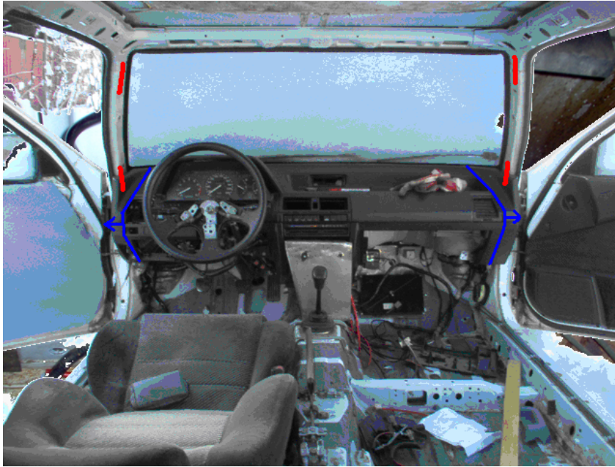
KUVIO 40. Kojetaulusta poistettavat osat merkitty sinisellä.
