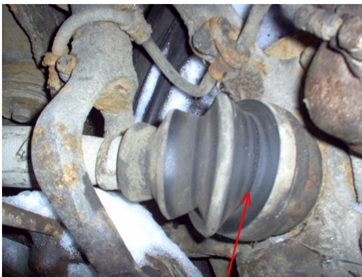
KUVIO 87. Vetonivelten suojakumi kuljettajan puolella.
