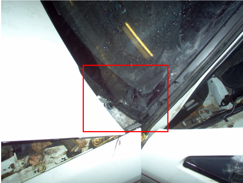
KUVIO 93. Ulkopuolen päävirtakatkaisijan vaijerikäyttöinen vetokahva.
