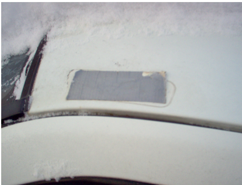
KUVIO 54. Antennin reikä väliaikaisesti paikattuna teipillä.
