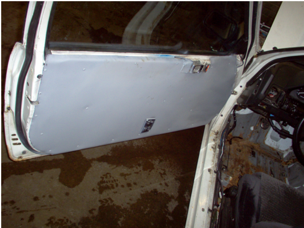
KUVIO 7. Kuljettajan puolen oven säännönmukainen verhoilu.
