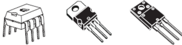
Kuva 44. Mikropiirikotelot; kuvassa vasemmalta oikealle: DIP-8, TO-220, TO-3P
