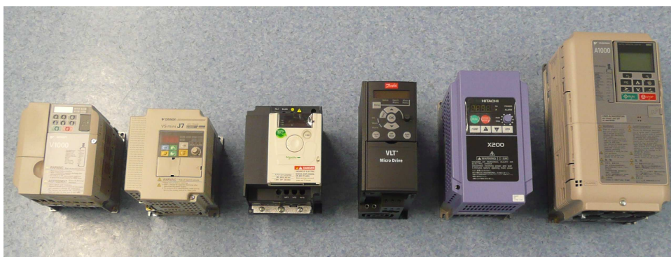
Kuva 6. 2,2 kW:n taajuusmuuttajat; kuvassa vasemmalta oikealle: Omron V1000, Omron VS mini J7, Schneider Altivar 12 (230 V), Danfoss MicroDrive FC51, Hitachi X200 ja Yaskawa A1000
