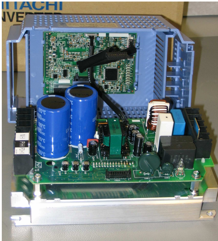
Kuva 39. Hitachi X200 0,75 kW 230 V -laite kuori avattuna; laitekuoressa olevaan piirikorttiin on sulautettu prosessori, I/O-liitännät sekä paneeli, muut toiminnot on sijoitettu alla olevalle suuremmalle piirikortille
