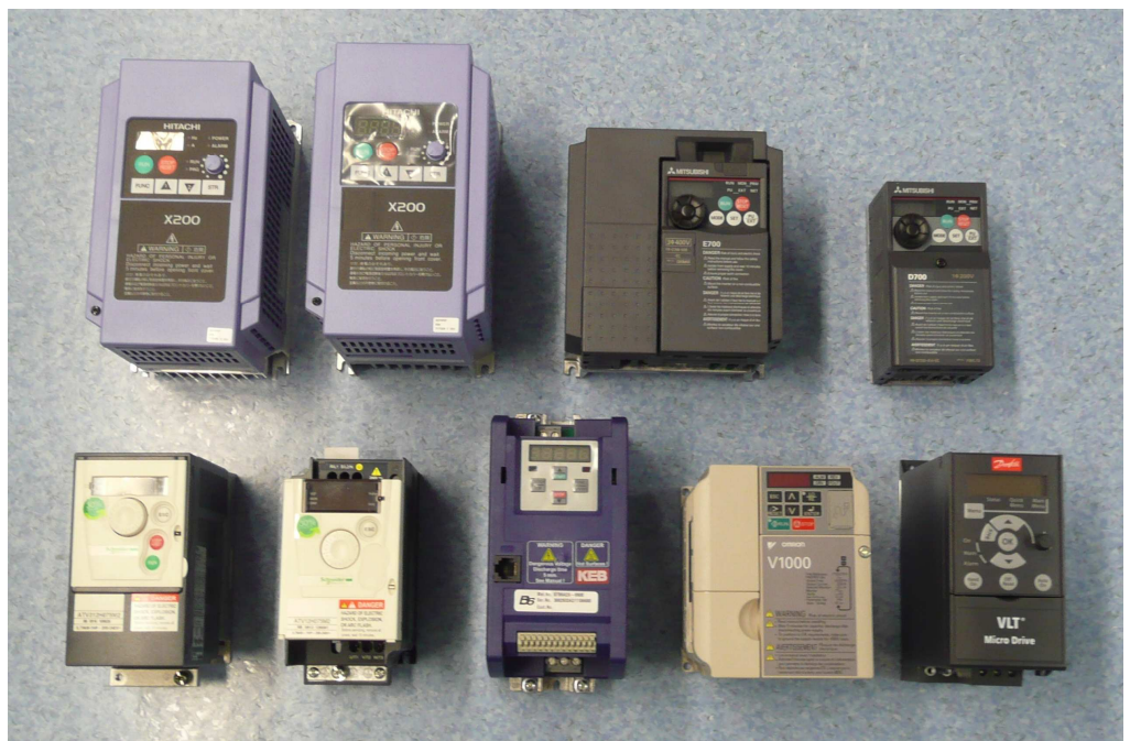
Kuva 4. Vertailun 0,75 kW:n laitteita; ylärivillä: Hitachi X200 (400 V), Hitachi X200 (230 V), Mitsubishi FR-E740, Mitsubishi FR-D720S; alarivillä: Schneider Altivar 312, Schneider Altivar 12, KEB Combivert B6, Omron V1000, Danfoss MicroDrive FC51; Combivert B6, V1000 sekä MicroDrive FC51 -laitteiden 230 V:n ja 400 V:n mallit ovat samankokoisia
