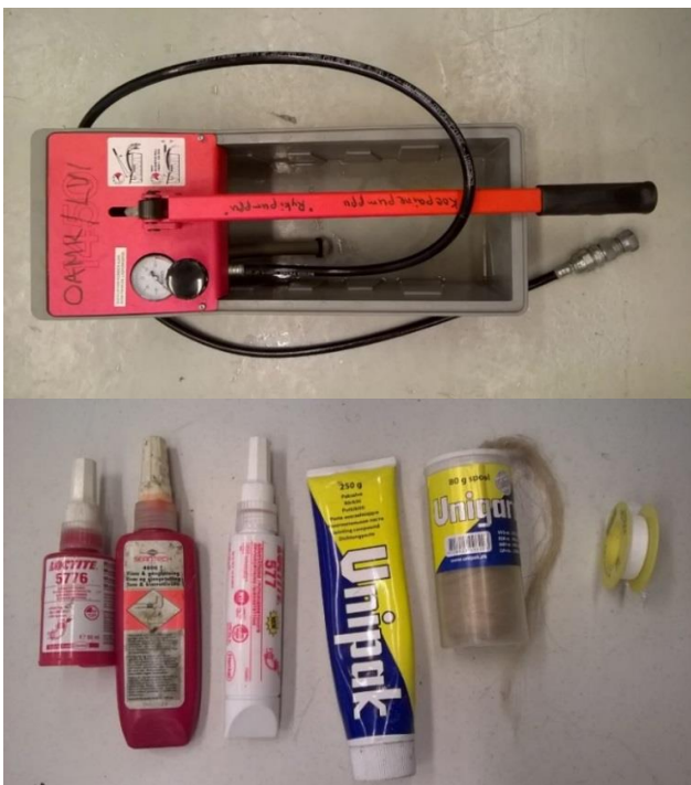
KUVA 7 Koepainepumppu ja putkikitti, hamppu, teippi ja Loctite 5776 ja 577 ja Seantech 4000 T -liimat.
