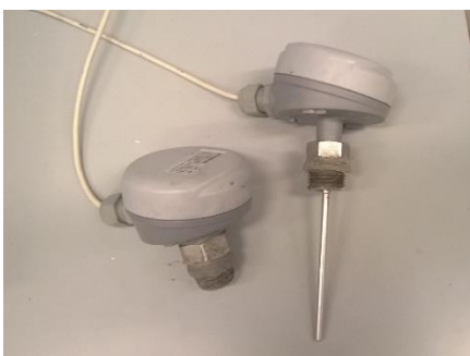
KUVA 4 Paine- ja lämpötila-anturi
