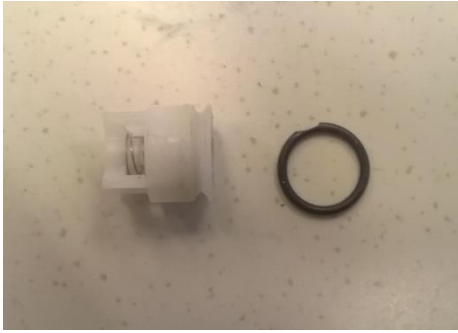
KUVA 33 Yksisuuntaventtiili ilman tiivistettä ja yksisuuntaventtiin tiiviste, josta on leikattu pala pois
