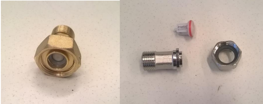
KUVA 24 Hela 381 liitin ja LVI 4482617, joka on irrallaan liittimen yläpuolella
