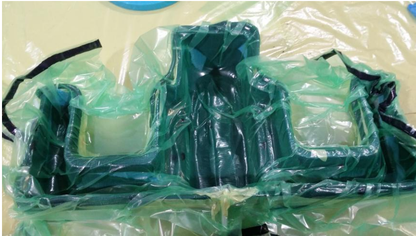
Kuva 8. Muotti suljettuna alipainesäkkiin ja alipaine imettynä muottiin.
