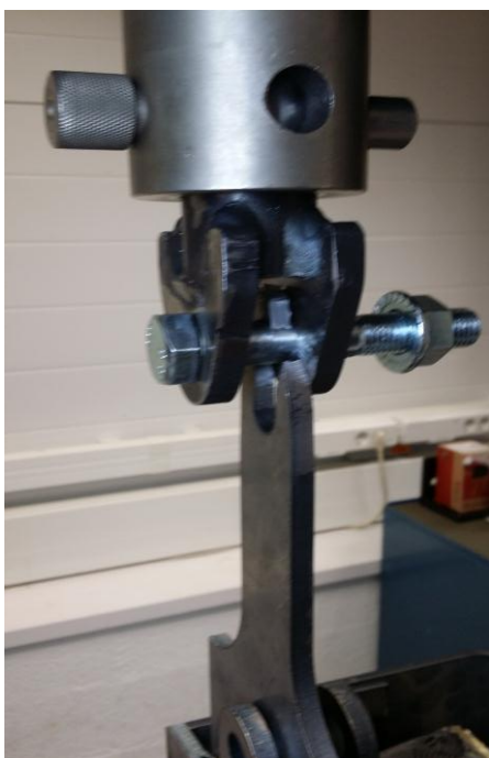
Kuva 21. Testauskehikko rikkoutunut testissä.
