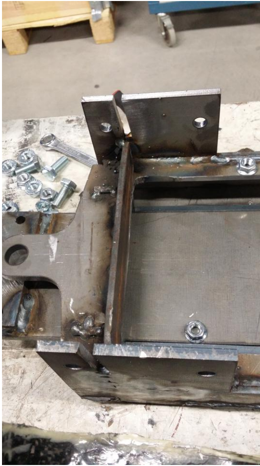
Kuva 18. Puskuripinnan vastakappaleen muokkaus
