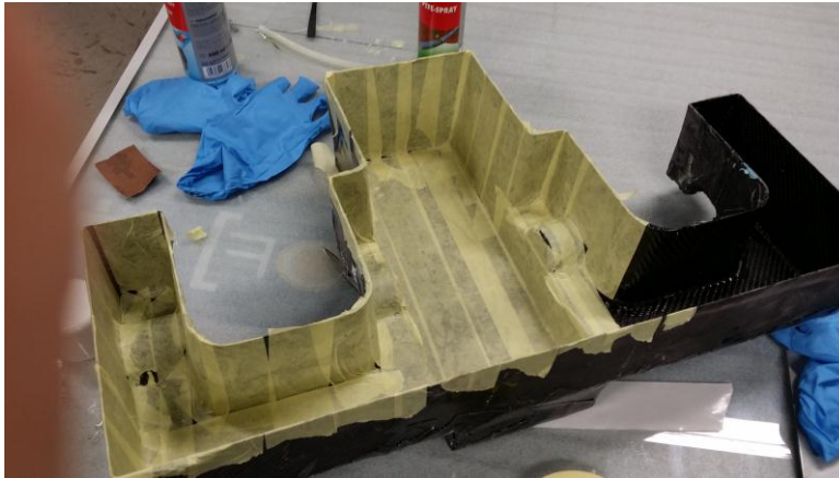
Kuva 9. Maalarinteippikerros helpottamassa alumiiniteipin irrottamista.
