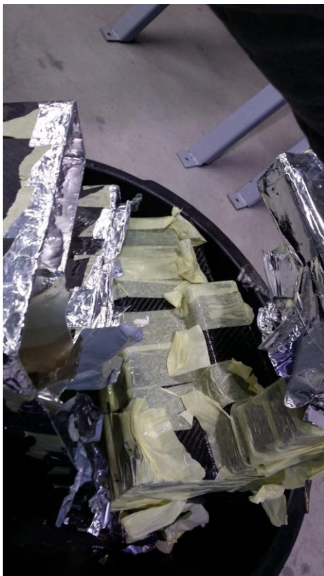
Kuva 11. Kovettuneiden vaahtovalujen irrotus kuorista
