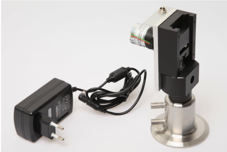
Kuva 20. Näytesekoittimen prototyyppi, virtalähde ja näytekyveti
