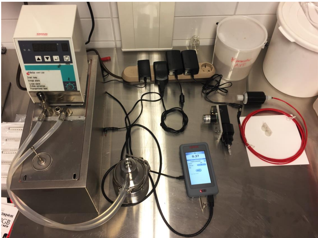
Kuva 24. Mittauslaitteiston komponentit vasemmalta alkaen: termostoitu vesihaude, PR 23 AC refraktometri, field communicator-näyttölaitte, uusi sekoitin, vanha sekoitin
