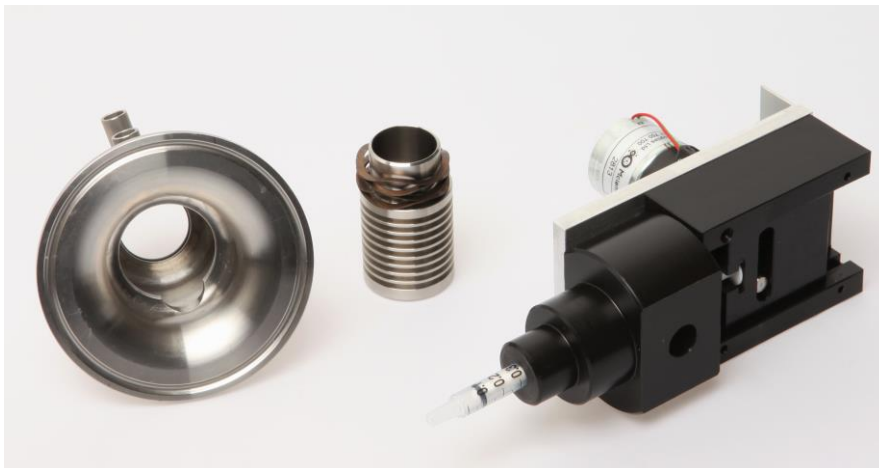
Kuva 21. Näytesekoitin ja laboratoriokyvetin osat
