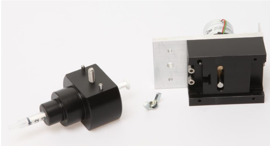
Kuva 22. Prototyypin osat irrotettuna toisistaan: runko-osa, jossa lääkeruisku paikoillaan sekä luistimekanismi moottoreineen taustalevyyn kiinnitettynä
