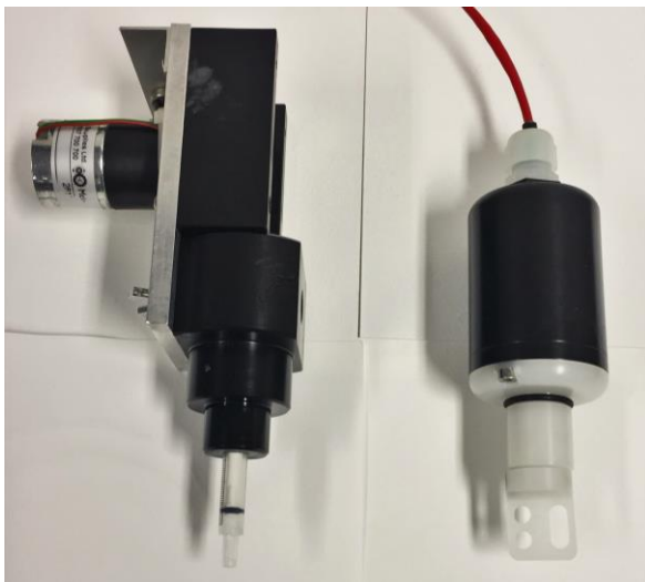
Kuva 23. Mittauksessa käytetyt näytesekoittimet rinnakkain; vanha sekoitin oikealla ja uuden sekoittimen prototyyppi vasemmalla.
