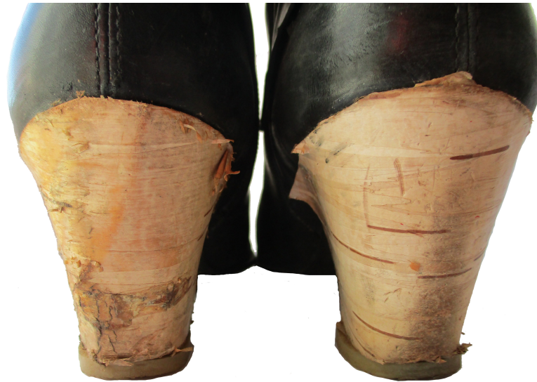
Kuva 20. Vasemman koron vahattu tuohi kesti paremmin käyttöä kuin oikean koron mattalakattu tuohi. Oikean koron takaosa tummui ja kului nastinlapun yläpuolelta.
