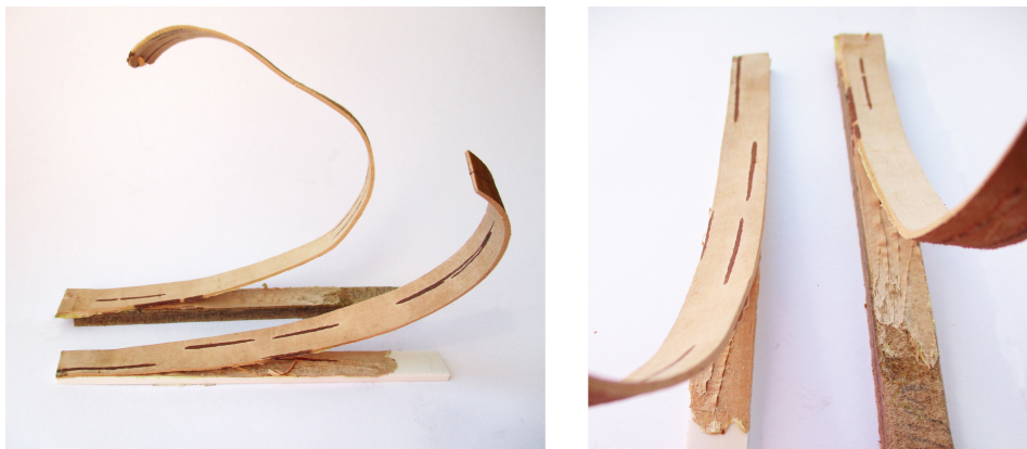
Kuva 28. Testikappaleiden tuohet repesivät siten, että tuohia jäi kiinni pohjamateriaaliin.
