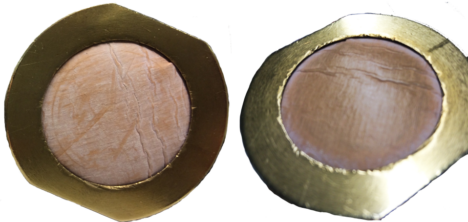
Kuva 25. Tuohen hankaustestausta HAMKin Martindale-laitteella. Vasemmalla tuohi ennen hankausta. Oikeanpuolisessa kuvassa tuohi on saanut kiillon, mikä johtunee hankausalustana käytetystä villakankaasta.
