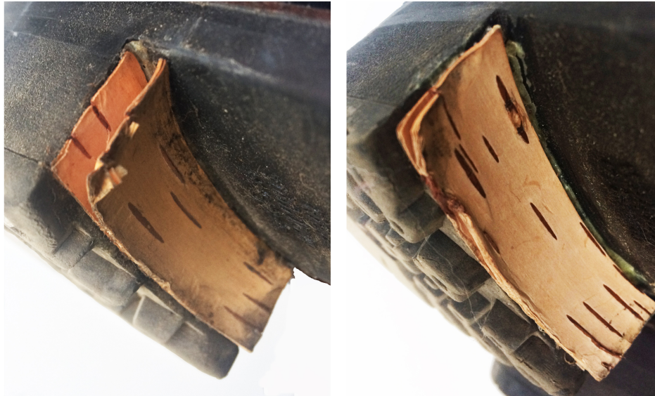
Kuva 17. Erityisesti vasen, eli vahattu koronpäällinen kärsi käytössä verrattuna oikeanpuolimmaiseen, eli mattalakattuun tuoheseen. Tuohen kerrokset alkoivat irtaantua liimatusta kerroksesta kastumisen ja kuivumisen tuloksena.
