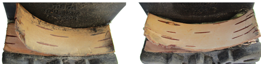
Kuva 18. Tuohinäytteet 13 ja 14 käyttöttestauksen jälkeen. Vasen tuohi on vahattu ja oikea mattalakattu. Lakattu tuohi on kestänyt kulutusta pinnaltaan hyvin. Tuohi on kuitenkin molemmissa testikappaleissa lähtenyt irtoamaan koroista kerroksittain.
