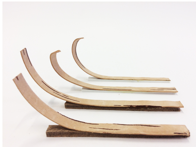
Kuva 27. Standardinmukainen testikappale (oik.) ja testauksessa käytetyt kappaleet (vas.).
