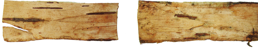
Kuva 16. Testinäytteet 11 (vasen) ja 12 (oikea) testauksen jälkeen. Vasen tuohipala (testipala 11) murtui alareunasta ja irtosi lyhyen käytön jälkeen. Oikea tuohipala (testipala 12) kesti käytössä 25 kilometriä. Testipalaan tarttui likaa kävelyssä ja materiaali tummui.
