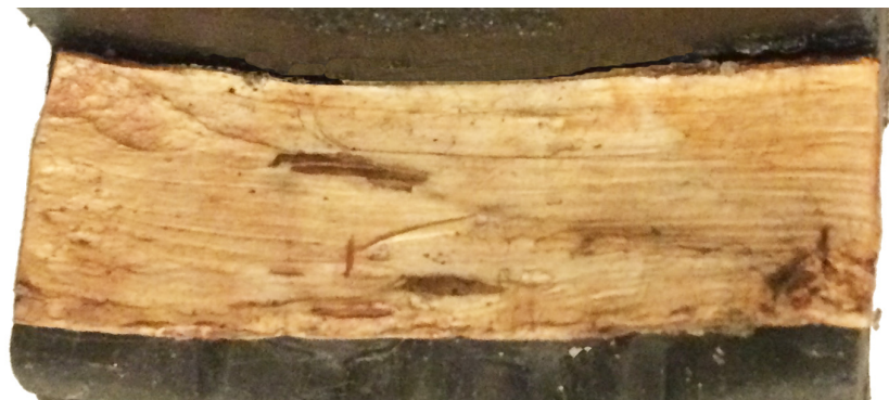
Kuva 15. Testipala 12 (oikea) käyttöperiodin puolella välissä. Pinta on käsitelty mehiläisvahalla ja siihen on tarttunut likaa. Tuohi on yhtenä kappaleena kiinni korossa. Tuohen kerrokset eivät ole lähteneet irtoaman reunoista.
