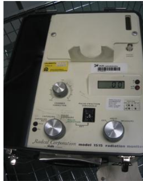
KUVA 2. Ulkoinen säteilymittari eli elektrometri, josta annokset saatiin Röntgen-yksikköinä.
