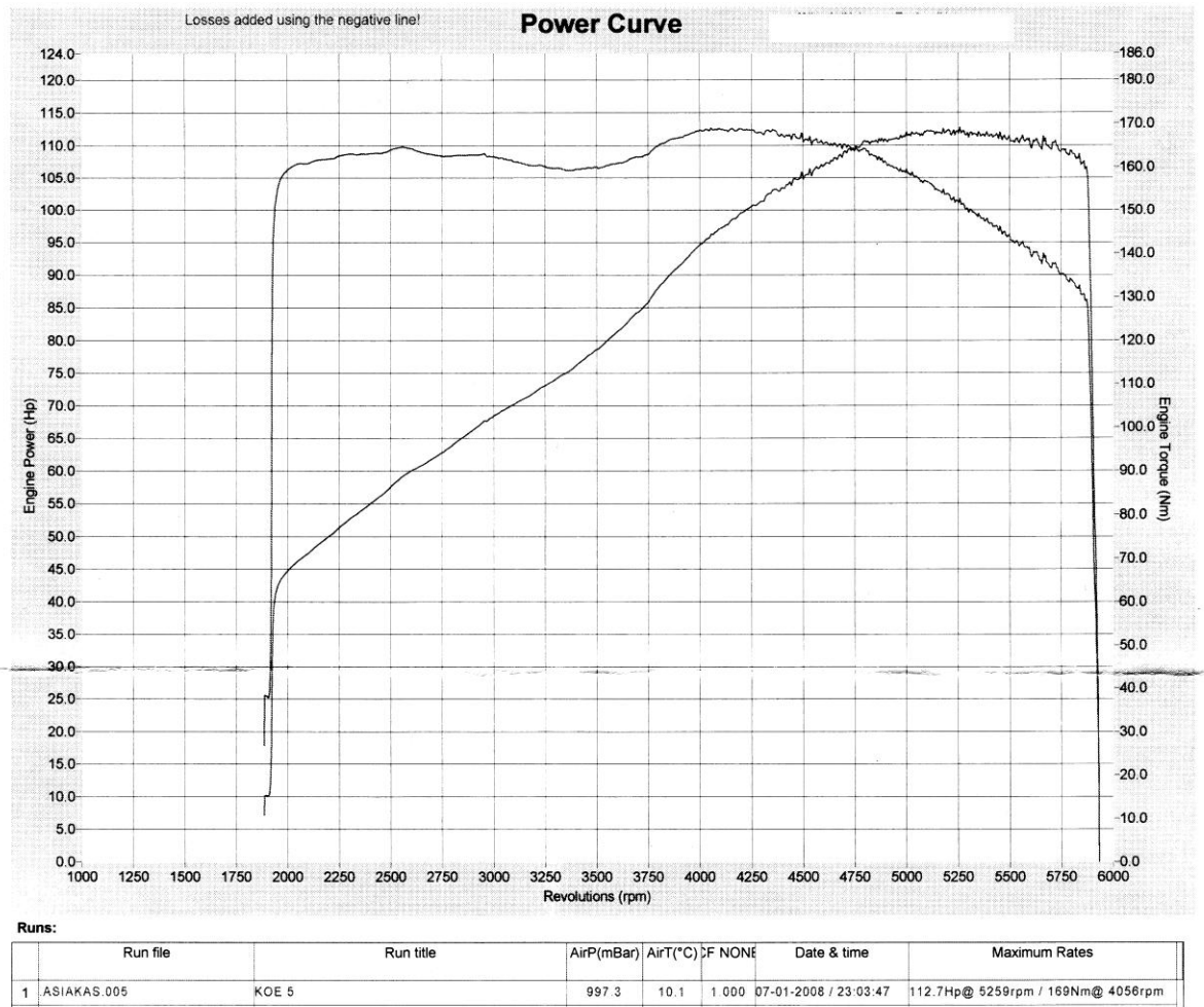
KUVA 25. Tehodynamometrimitaus alkuperäisellä ruiskulla.
