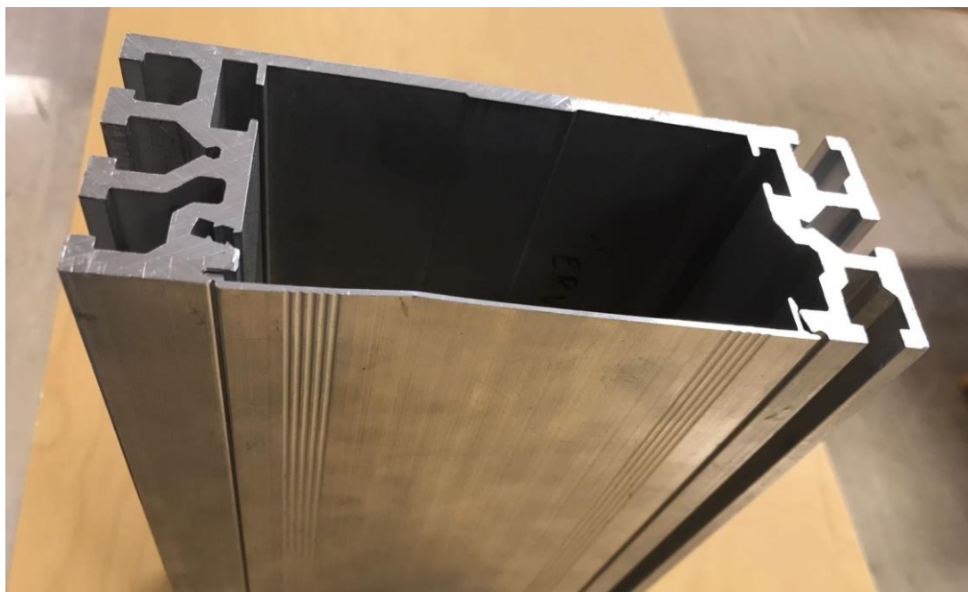
Kuva 2. Alumiinirunko ja kansilevy. Kuljetin Oy, 2017.
