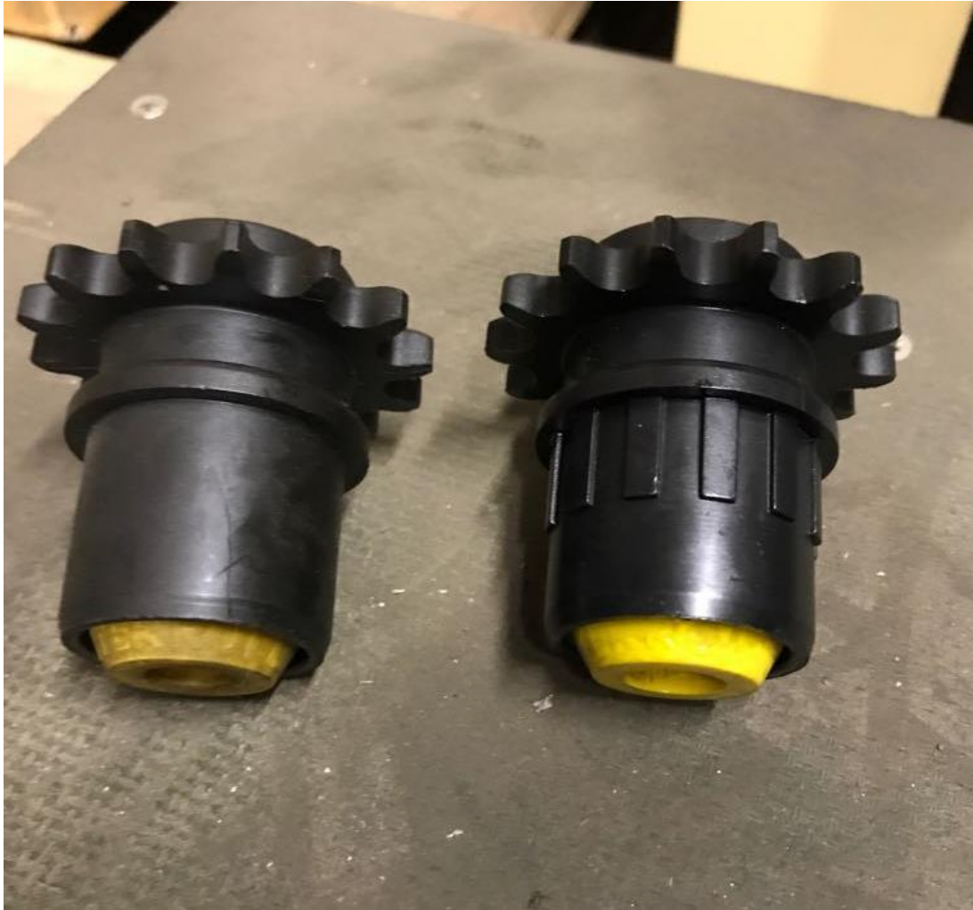
Kuva 10. Rullien vetopäät: vasemmalla kitka-akkumuloiva ja oikealla pakkovetoinen (Kuljetin Oy, 2017)
