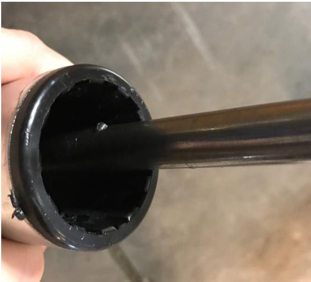
Kuva 11. Rulla ilman vetopäätä (Kuljetin Oy, 2017)
