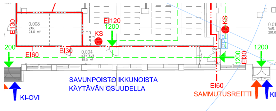
Kuva 9. Painovoimainen savunpoisto ikkunaseinällä esimerkkikohteessa
