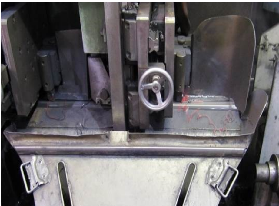
Kuva 10. Ulkopuolinen höylä (SSAB esittelymateriaali 2017)
