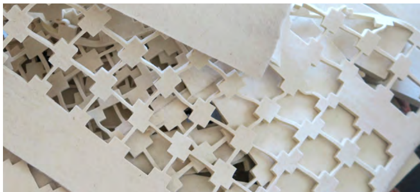
Kuva 9. Jämsän Huopatehtaan huopaa muotoon stanssattuna.
