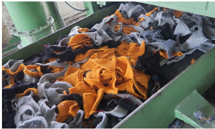
Kuva 22. Leikkuujätettä hihnalla menossa revintään.
