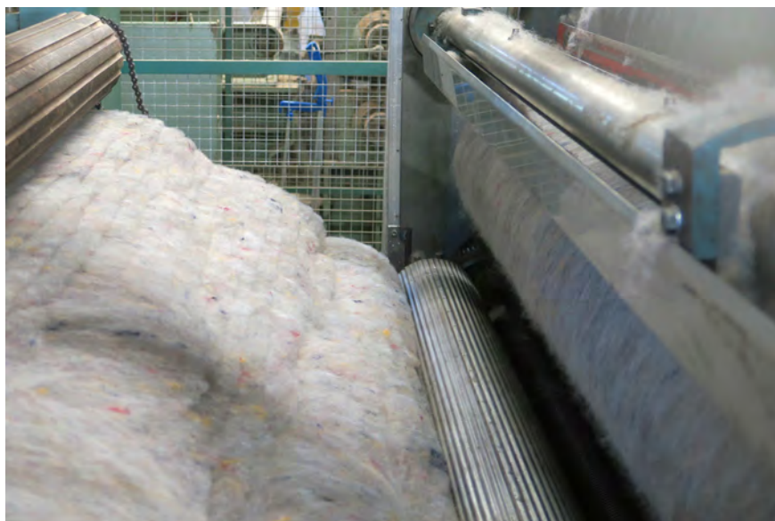
Kuva 29. Pirtin Kehräämön karstauslinja.
