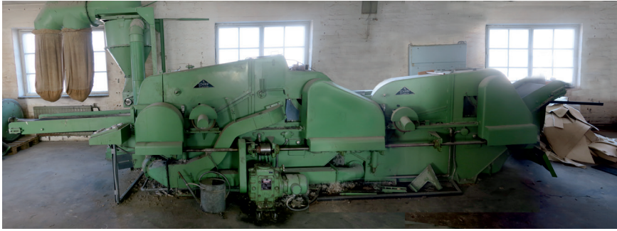
Kuvat 21. Jämsän Huopatehtaan repimiskone.
