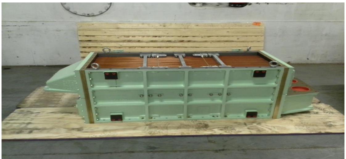
Kuva 11. Välijäähdytin Wärtsilä 6L46F CR (Pekka Pohtila 2015)
