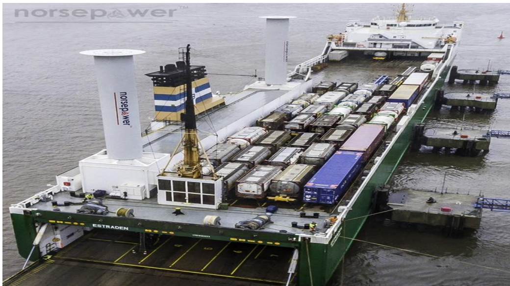
Kuva 21. Roottoripurjeet Boren Ro-Ro alus Estradenilla (Norsepower.com)
