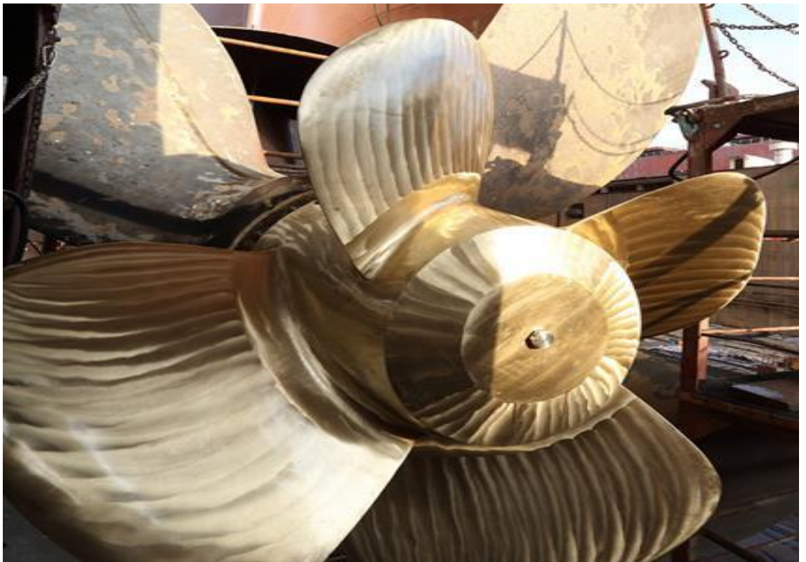
Kuva 17. Wärtsilä EnergoproFin asennettuna vanhaan potkuriin (Wärtsilä 2016)
