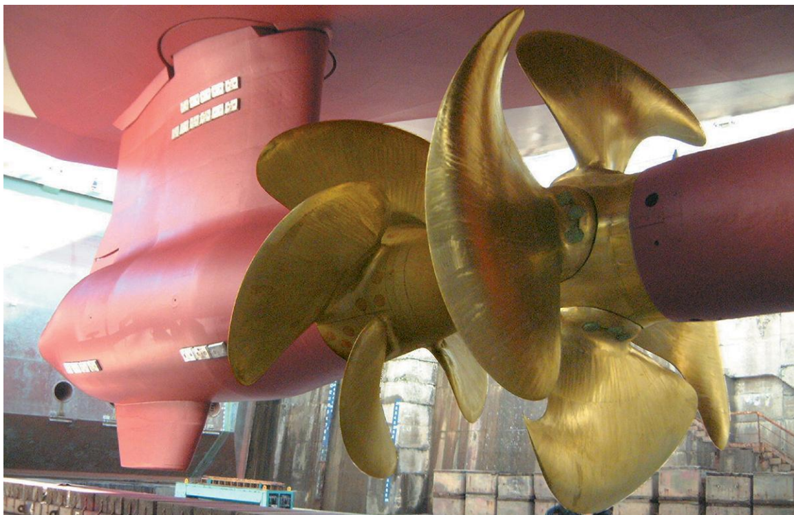
Kuva 19. ABB Azipod CRP (ABB CRP propulsio 2001)
