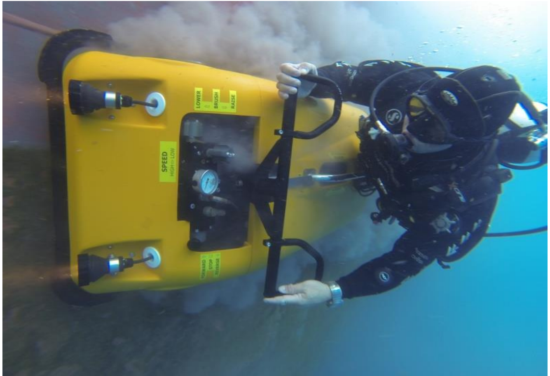
Kuva 24. Kasvuston poistoa aluksen pohjasta (Aluksen pohjan pesu 2015)
